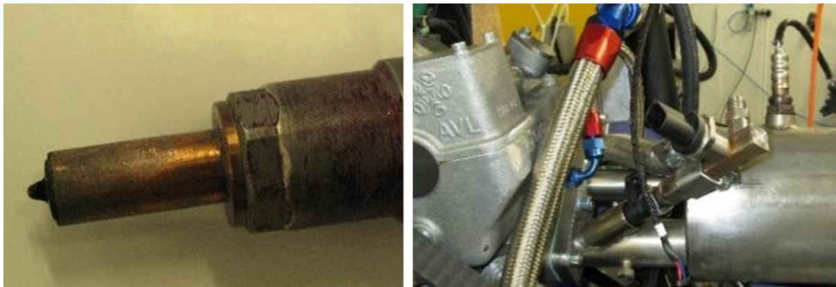
Obrázek 10-7 Použitý vstřikovač s chladičím prstencem a systém vefukování plynného paliva
