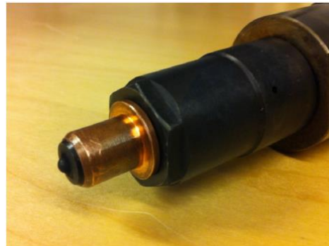
Obrázek 2-16 Tryska vstřikovače s prstencovým pasivním měděným chladičem [84]
