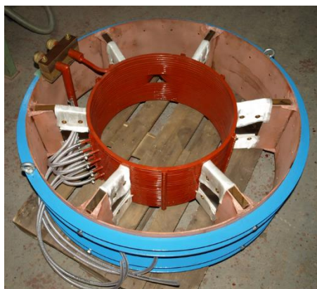
Obrázek č. 12: Opravená indukční cívka pro kalení válců
