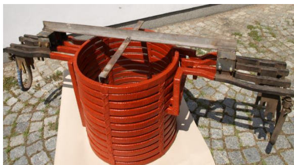
Obrázek č. 7: Opravená cívka pro vakuovou pec
