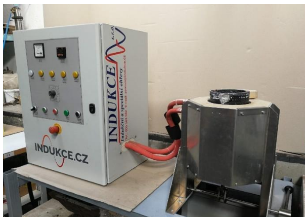
Obrázek č. 6: Zdroj a tavící pec na 10 kg materiálu
