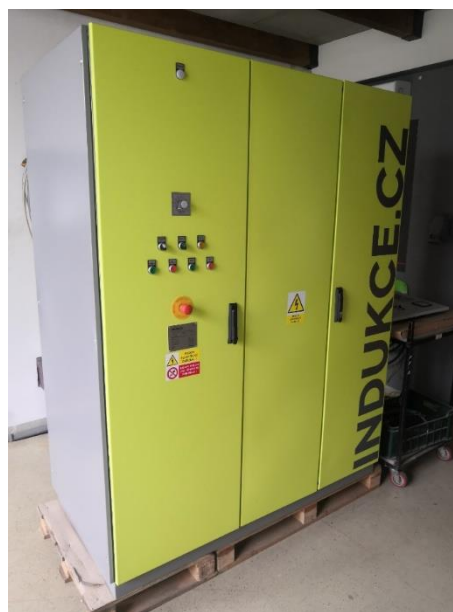
Obrázek č. 9: Zdroj pro tavicí pec na 100 kg materiálu
