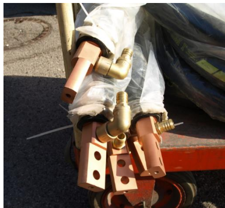
Obrázek č. 13: Zakončení chlazených kabelů
