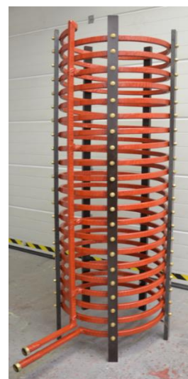
Obrázek č. 10: Nová cívka pro ohřev nerezové trubky
