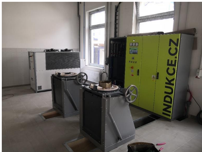
Obrázek č. 11: Sestava tvořená zdrojem, dvěma pecemi a chladicí jednotkou
