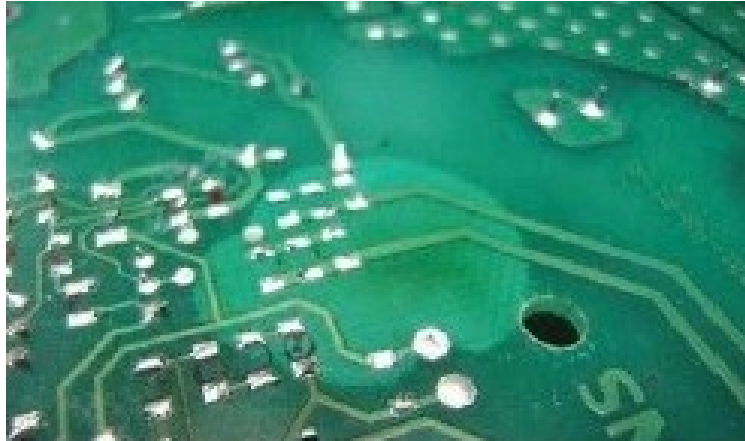
Obr. 9 – Zabarvení desky v místě delaminace [11]
