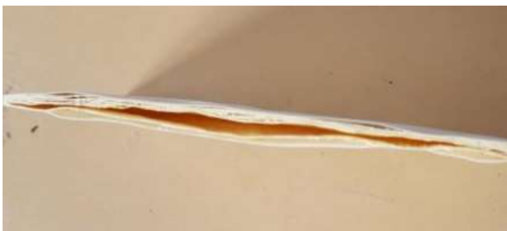
Obr. 20 – Delaminovaná deska z CEM1 po projití procesem HASL
