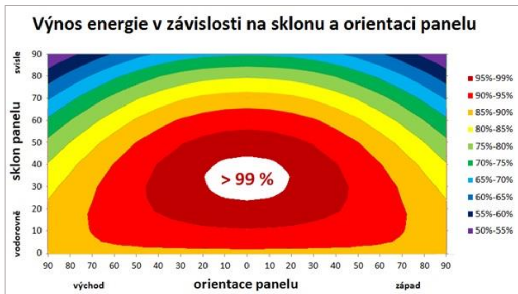
Obrázek 2.2 – Výnos energie v závislosti na sklonu a orientaci FV modulu 20
