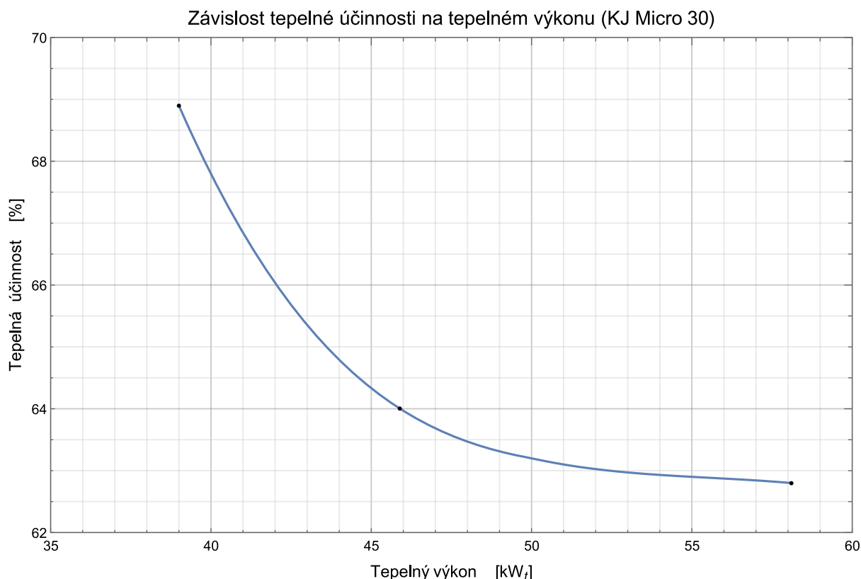
Graf 2.8 – Závislost tepelné účinnosti na tepelném výkonu KJ TEDOM Micro 30 76
