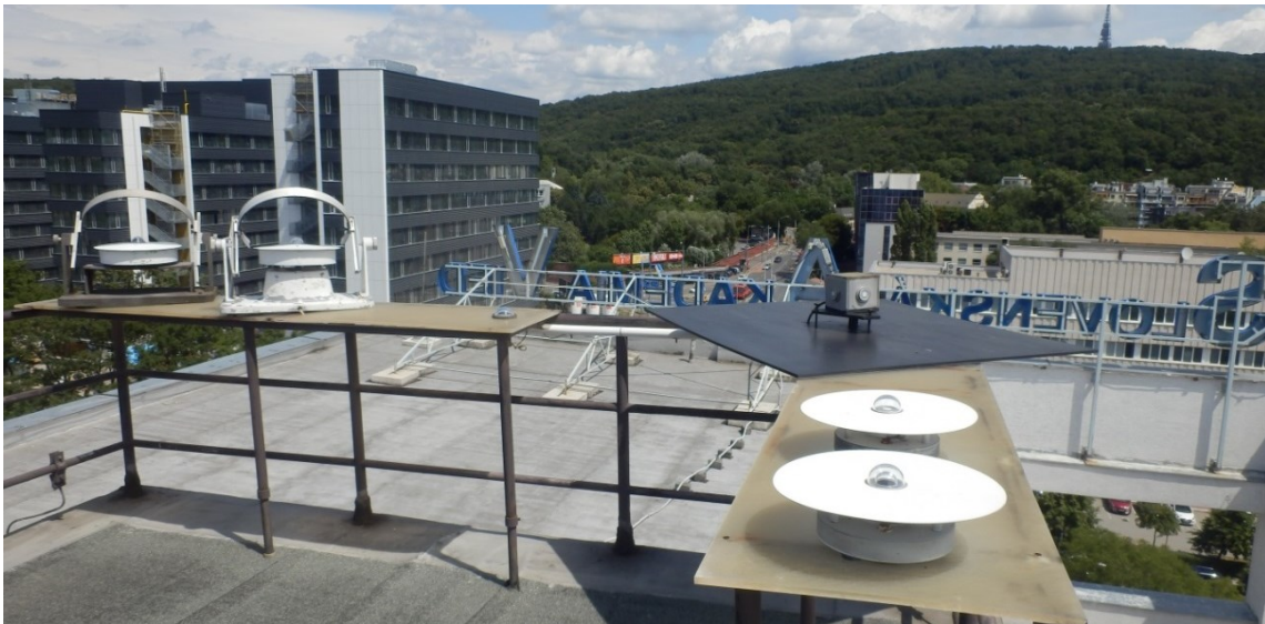
Obr. 22 Pohled na soustavu čidel pro měření denního osvětlení v ÚSTARCH SAV v Bratislavě
