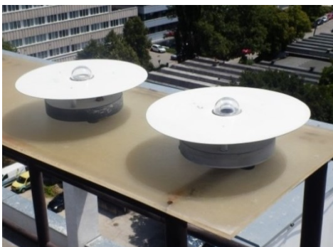
Obr. 24 Čidla pro globální osvětlenost a globální záření, jas horizontu a svislé osvětlenosti
