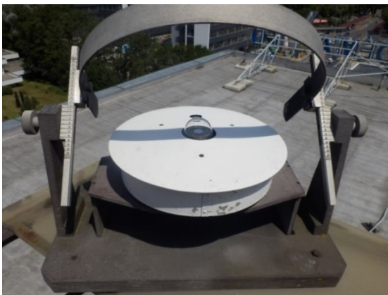
Obr. 23 Čidlo pro měření difúzní osvětlenosti, čidlo pro měření difúzního záření
