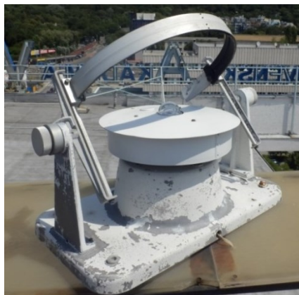
Obr. 23 Čidlo pro měření difúzní osvětlenosti, čidlo pro měření difúzního záření
