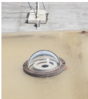
Obr. 24 Čidla pro globální osvětlenost a globální záření, jas horizontu a svislé osvětlenosti
