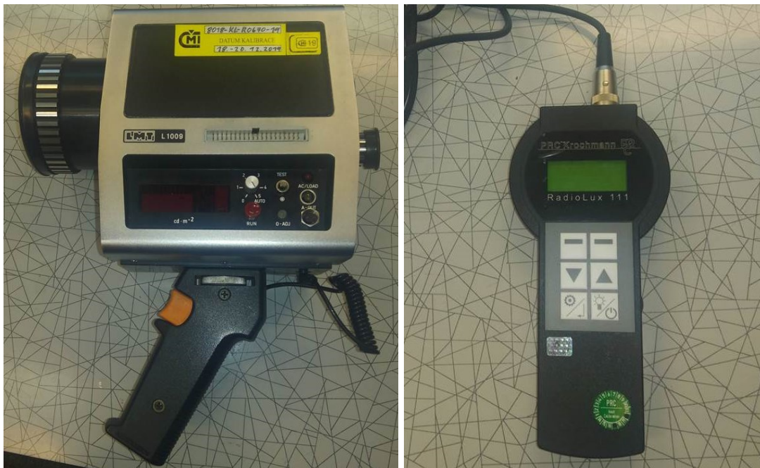
Obr. 47 Jasoměr a luxmetr pro měření činitele odrazu světla dodaných vzorků na ČVUT FEL
