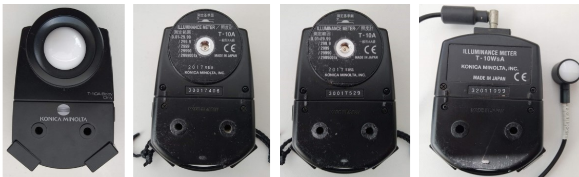
Obr. 35 Čidla luxmetru T10A, pro jižní místnost, pro severní místnost a vodotěsné čidlo T-S10w
