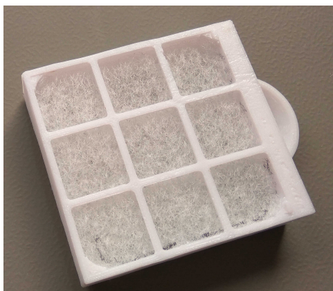
Obrázok 5.14: Vytlačený držiak aj s osadeným vzduchovým filtrom. Zdroj: autor práce
