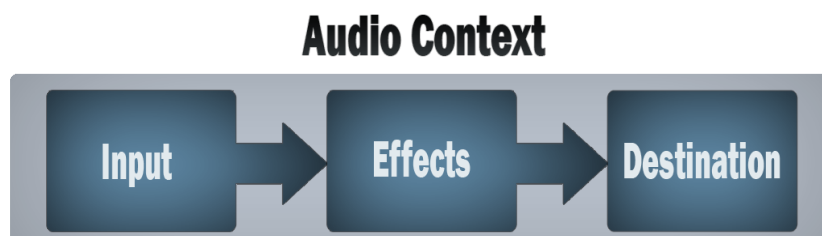
Obrázek 3.4: Schéma Audio contextu ve Web Audio API (zdroj: [5])
