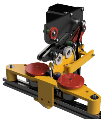
(b) : Realizace konceptu manipulace s jádrem mezi dvěma hnanými válečky a zásobníkem.
