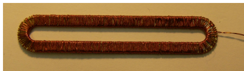
Obrázek 6.22: Ručně navinuté jádro, sloužící jako referenční, se 500 závity.
