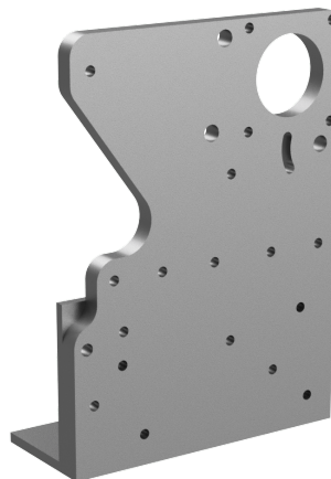
Obrázek 4.14: Zadní deska navíjecí hlavy se všemi otvory k připevnění ostatních součástí.
