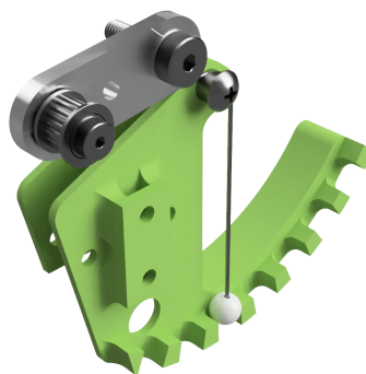
Obrázek 4.26: Napínací páka s řemenicí a držák napínání se zkrutnou pružinou a její aretací.
