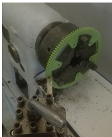
(a) : Vyhlazení drážky pro kuličky na ozubení na soustruhu.
