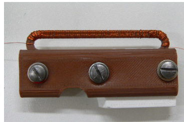
(b) : Vyjmutá kleština s jádrem po dokončení navíjení.
