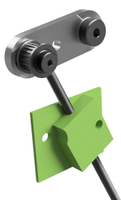
(a) : Přetrvávající design napínání řemenu bez pružného elementu šroubem zespolu.
