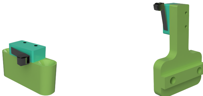
(a) : Koncový spínač přišroubovaný do podložky vedle navíjecí hlavy.
