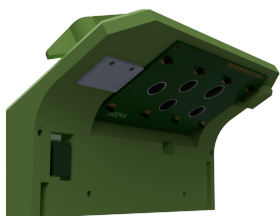
(a) : Pohled na box s řídicí elektronikou zezadu. Je vidět přimontovaný displej a enkodér.
