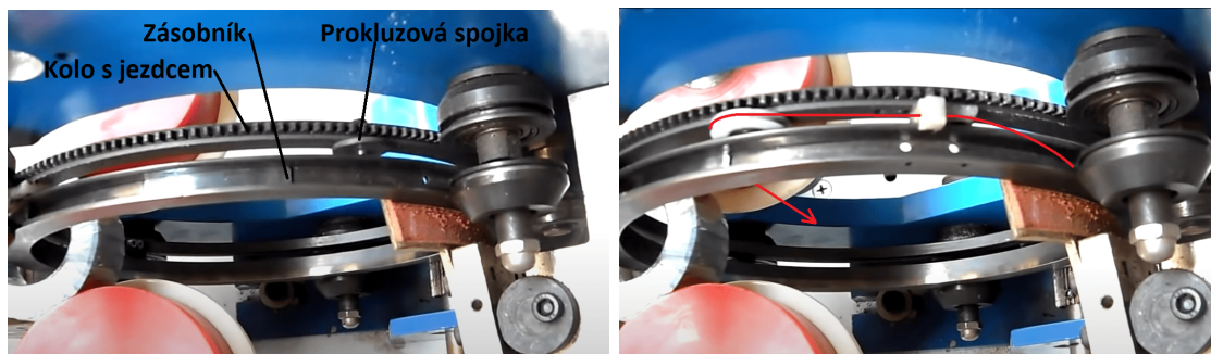
(a) : Pohled shora na zásobník a ozubené kolo s jezdcem. Jezdec není vidět.
