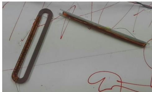
Obrázek 3.4: Manuálně navíjené jádro, kterým je provlékán člunek s drátem.
