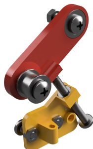
Obrázek 4.27: První verze napínací páky. Napínání pomocí utahování šroubu.
