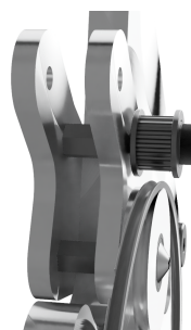
(b) : Pohled na dvojici pák rozevírání zásobníku spojených distančními sloupky.
