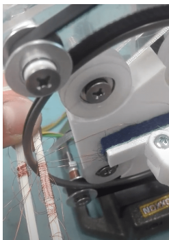
Obrázek 4.1: První pokusy o navíjení drátu s navíjecí hlavou vypálenou laserem z plexiskla.
