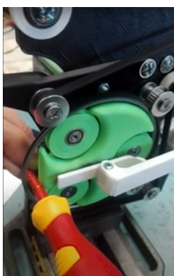
Obrázek 4.2: Navíjení drátu na dřík šroubováku na navíjecí hlavě vytištěné na 3D tiskárně.
