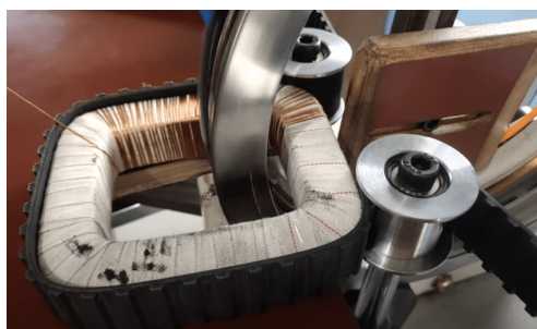
Obrázek 4.6: Otáčení racetrack jádrem pomocí obepnutého řemenu.
