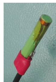
(c) : Měřicí cívka s kostičkou vytištěnou na 3D tiskárně.
