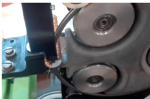
Obrázek 4.35: Plastový pásek přitlačující drát směrem k zásobníku.
