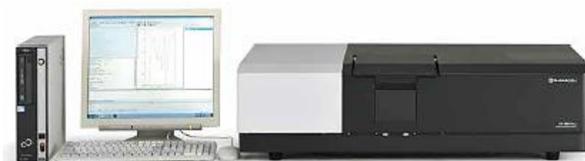
Obr. 6.2: Měřicí pracoviště pro měření absorpčních spekter UV-VIS-NIR Shimadzu UV-3600 [39].
