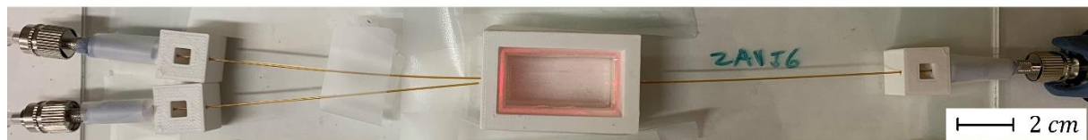
Obr. 7.9: Fotografie hotových vzorků vedoucích optický signál v jednorázové formě se zalitými pigtaily umístěnými v podpoře pro vlákna pro zabránění jejich vylomení s připojeným laser testerem FLS-240 s vlnovou délkou 635 nm,
