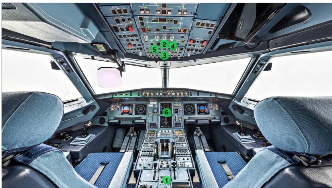
Obrázek 35 – Úkony po spuštění ENG2 (upraveno autorem) [37]
