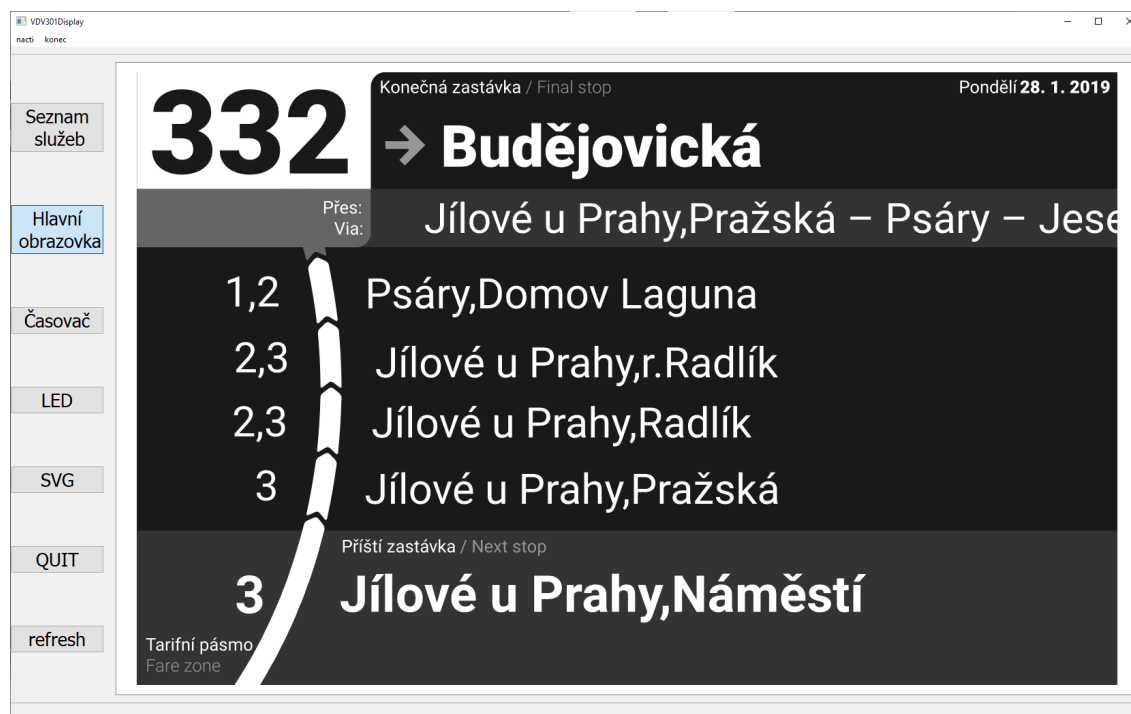
Obrázek 34: Simulace TFT-LCD displeje v VDV301display.exe (autor, 2021)
