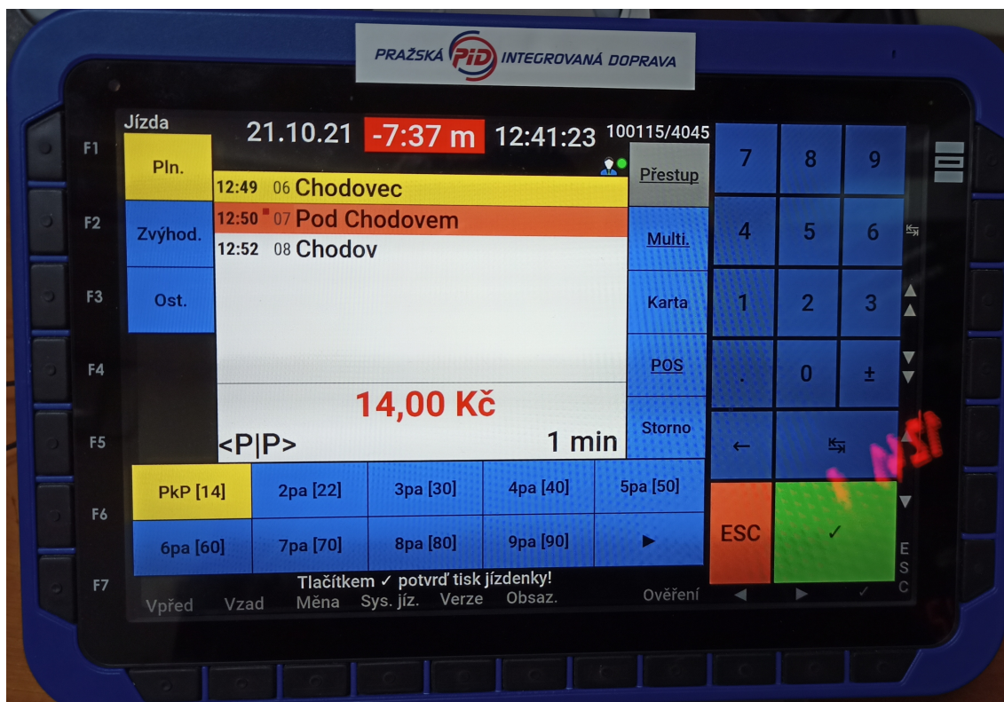
Obrázek 20: Základní obrazovka skutečného zařízení Mikroelektronika OCC3 (Autor, 2021)
