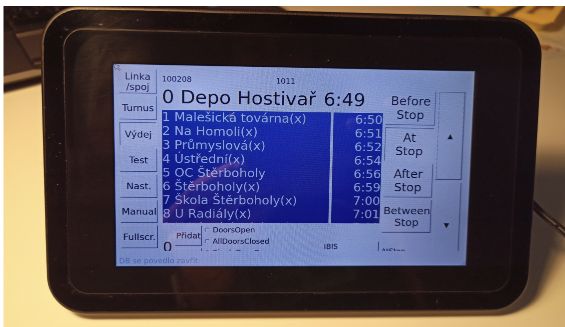
Obrázek 19: program VDV301tester běžící na Raspberry Pi 3 s dotykovým displejem (Autor, 2021)
