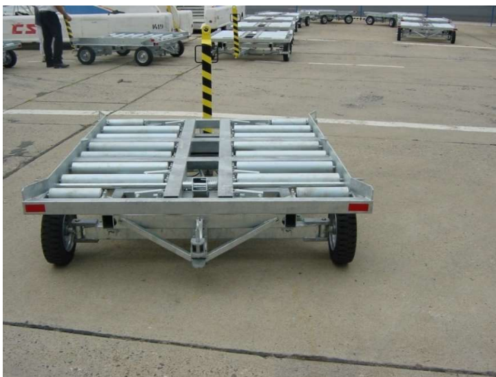
Obrázek č. 5- kontejnerový vozík typu CAK
