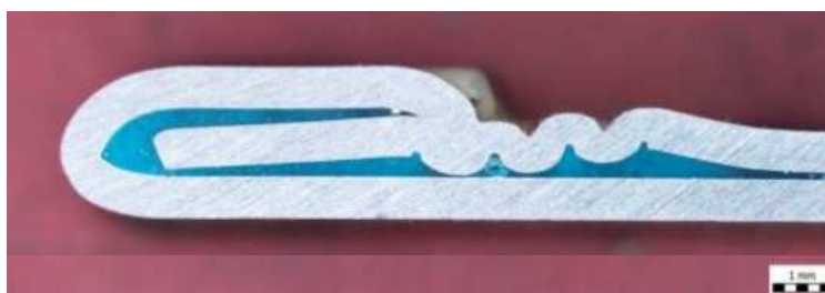
Obr. 8.47 – Pohled v řezu reálným vzorkem (tl. plechů 0,65mm) [P6]
