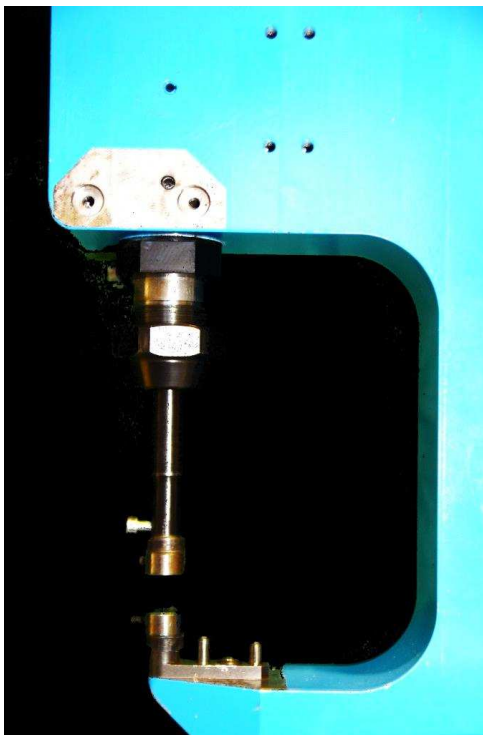
Obr. 8.22 - Drážkový nástroj upnutý v pneumatických kleštích
