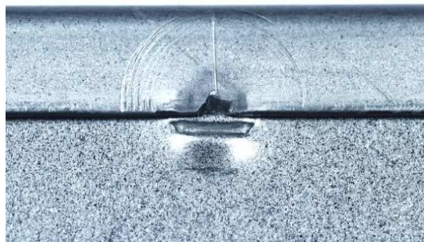
Obr. 8.30 - Detailní pohled shora na lem s drážkovou fixací. [P11]
