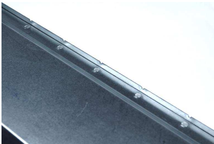
Obr. 8.31 - Sestava zkušební vzorku připravená pro lemování [P11]
