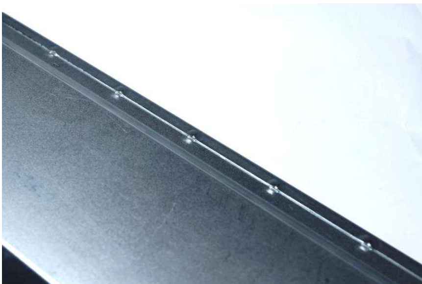
Obr. 8.32 - Zalemovaný zkušební vzorek s více pozicemi drážkové fixace [P11]
