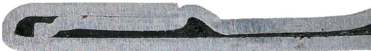
Obr. 5.20 - Řez fixačním bodem lemového spoje
