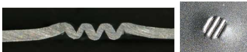
Obr. 8.43 - Experimentální vzorek drážkování [P5]
