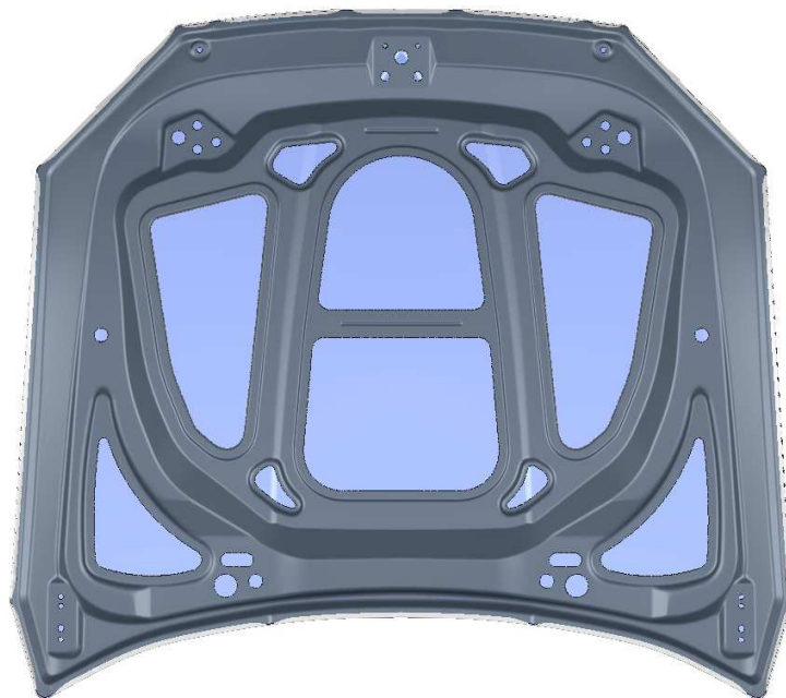
Obr 8.70 – Výsledek simulace lemování [P12]
