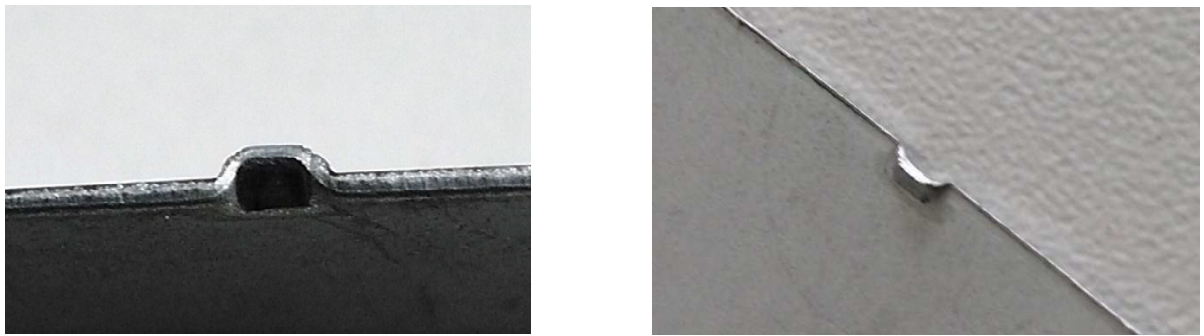
Obr. 7.9 - Háček na stojně vnějšího plechu připraveného pro lemování [P9]
