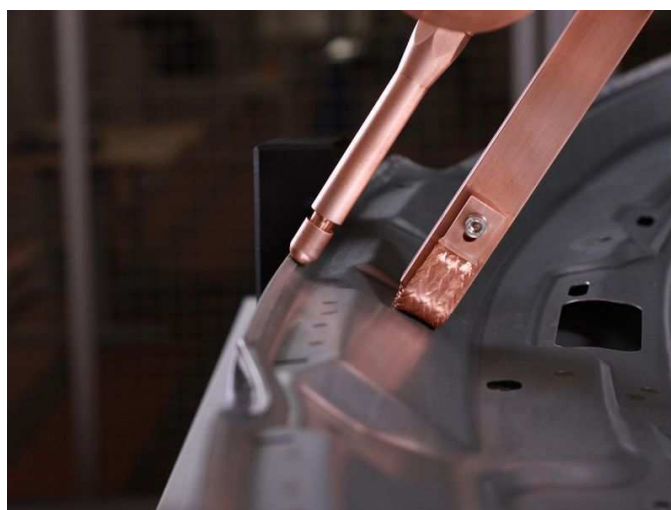
Obr. 5.12 – Detail na proces fixace lemového spoje metodou VarioPicker [17]
