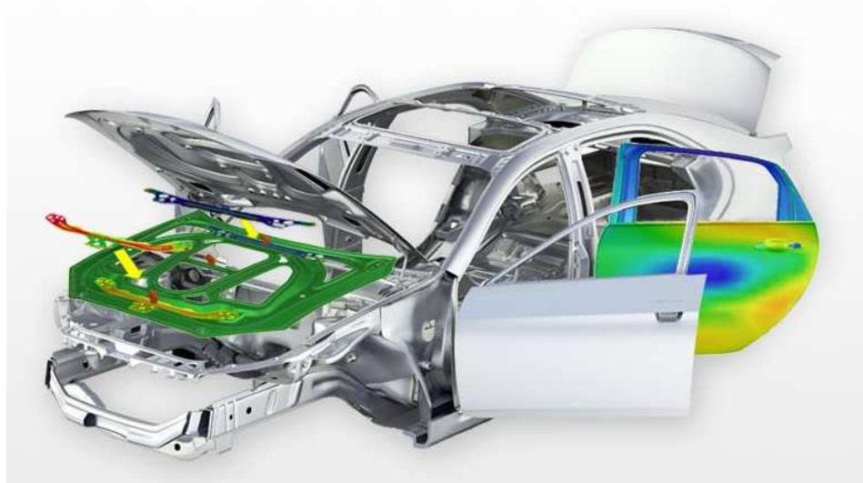
Obr. 8.11 – Příklad sestavy karoserie vozu
