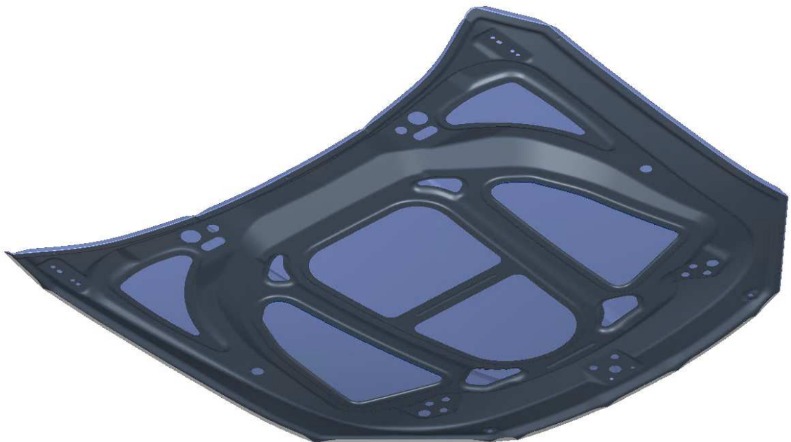
Obr. 8.65 - Sesazení vnějšího a vnitřního dílu pro lemování [P12]
