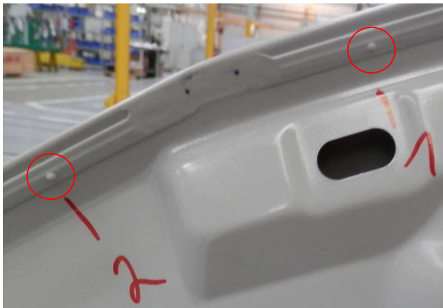
Obr. 9.2 – Bubliny na jemném těsnění lemového spoje
