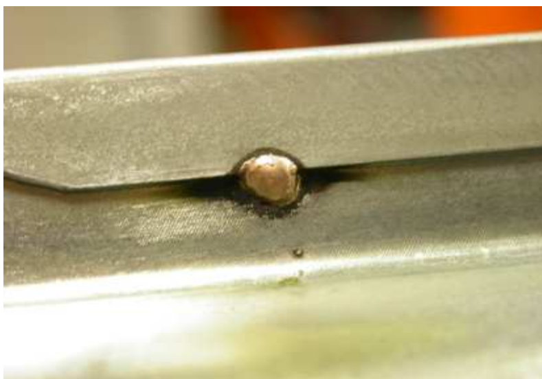
Obr. 5.2 - Fixace lemu průvarem pomocí technologie MIG pájení
