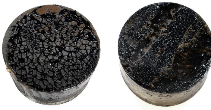
Obr. 121. Vzorky pro tahovou zkoušku po kohezním (vlevo) a adhezním (vpravo) porušení.
