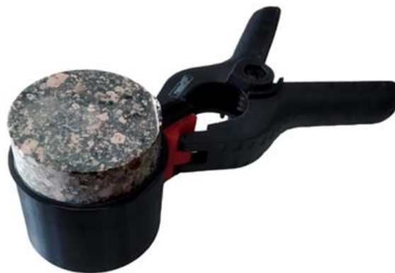
Obr. 116. Příklad upnutí jádrových vývrtů kameniva do plastové objímky z 3D tiskárny pro případné zamezení úniku asphaltového pojiva.
