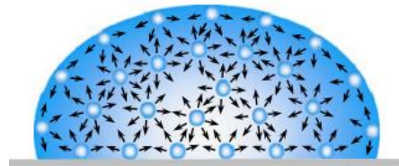
Obr. 32. Princip silové interakce mezi molekulami kapaliny. [103]
