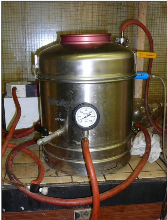
Obr. 53. Vakuová komora sloužící k odstranění zbylého zachyceného vzduchu v asfaltové směsi uložené v pyknometru.
