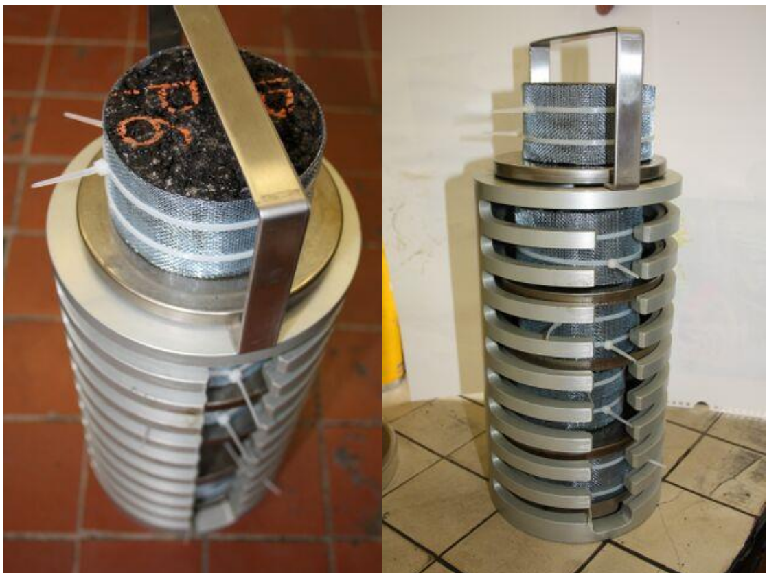
Obr. 38. Umístění zkušebních těles do nástavce přístroje PAV.
