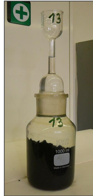
Obr. 54. Pyknometr naplněný odvzdušněnou destilovanou vodou po referenční značce.
