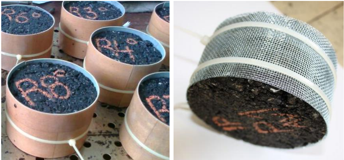
Obr. 37. Příprava zkušebního tělesa umístěním do ochranného límce z PVC (vlevo) a ocelové sítky (vpravo).
