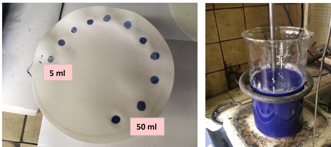
Obr. 87. Zkouška methylenovou modří – filer Plešovice, objem roztoku barviva s přesností na 1 ml, kterého bylo nutno dodat, aby barevný kruh vydržel po dobu 5 minut.
