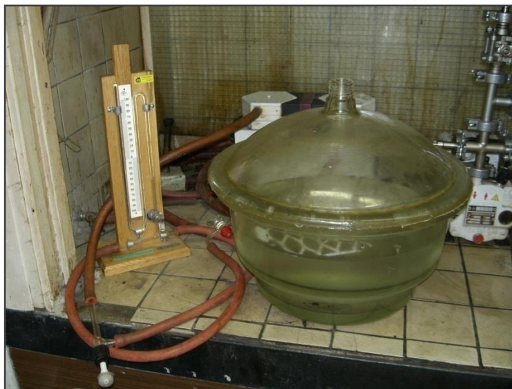
Obr. 56. Skleněná vakuová nádoba na sycení zkušebních těles.
