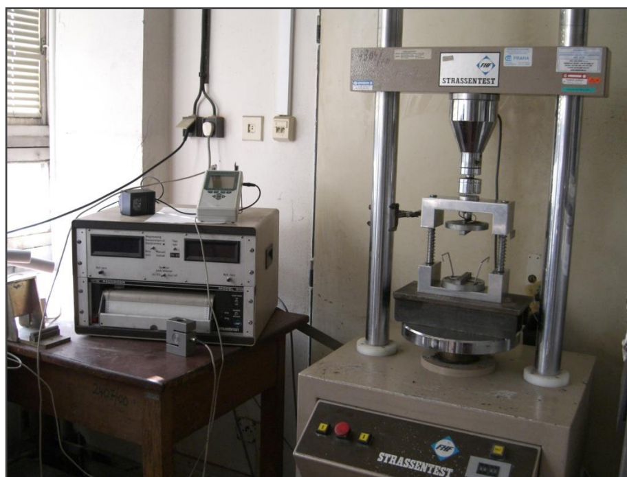
Obr. 55. Lis s dvěma tlačnými pásy pro stanovení pevnosti v příčném tahu.
