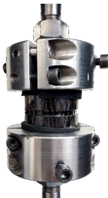
Obr. 117. Příklad upnutí vzorku při zkoušce „Direct pull test“ – selhání soudržnosti.
