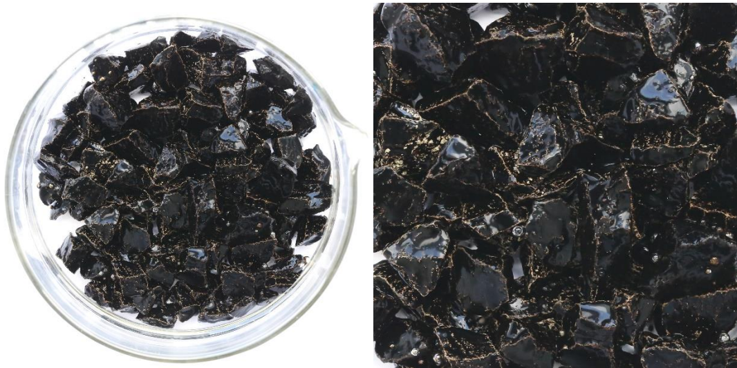
Obr. 99. Digitální fotografie kameniva obaleného asfaltovým pojivem po exponování obnažovací vodou – celý snímek (vlevo), čtvercový výřez (vpravo).
