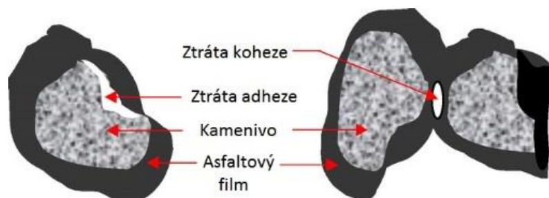
Obr. 24. Schéma ztráty adheze a koheze v asphaltové směsi.
