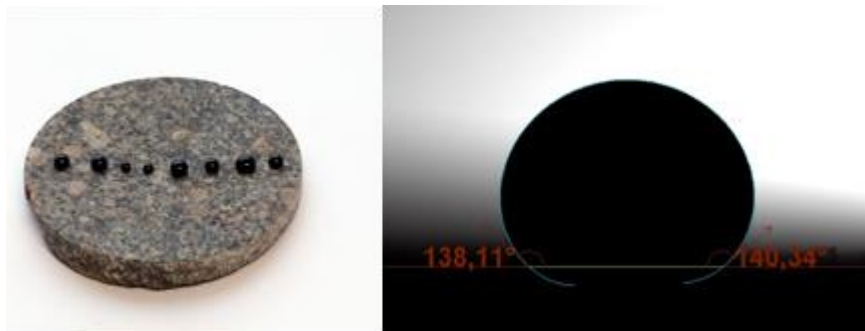
Obr. 115. Kapky zahřátého asfaltového pojiva na výbrusu kameniva (vlevo) a vyhodnocení kontaktních úhlů pomocí povrchového tenzometru a Young-Laplaceovy rovnice (vpravo); dvě nejmenší kapky byly z měření vyřazeny pro nesplnění kritéria minimálního objemu.
