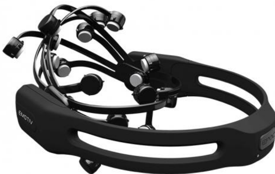
Obrázek 5 – EMOTIV EPOC+ 14 kanálové mobilní EEG zařízení použité během výzkumu; zdroj: https://www.emotiv.com/epoc
