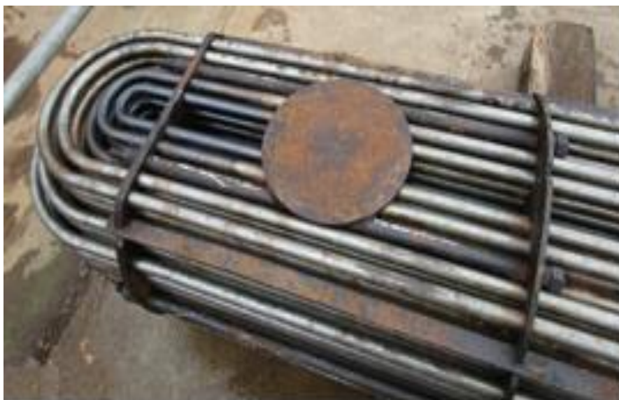
Obr. 2. Ochranná deska, která zabraňuje korozi trubek proti vstupu trysek pláště [6].
