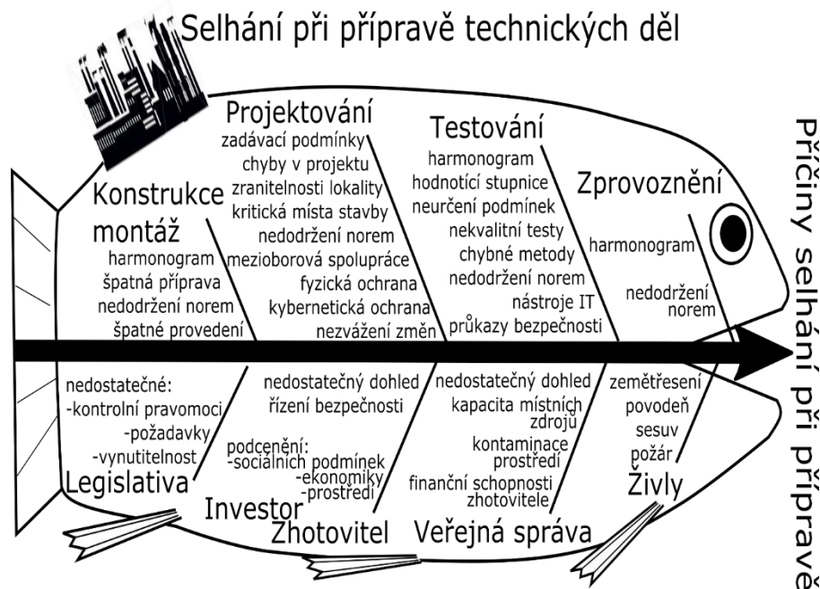
Obr. 1. Příčiny selhání koexistence technického díla a jeho okolí z důvodu nedostatků či chyb při projektování, zhotovení a spouštění technického díla do provozu.
