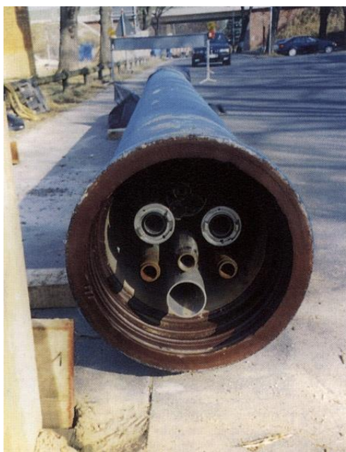
Obr. 10. A-Příklad sdružené chráničky HYDROS pro vedení 4. kategorie dle ČSN 73 6005, tj. pro přípojková vedení, zdroj HYDROS ( www.hydros.de ); Obr.10.B – Příklad varianty řešení ze sousedního Německa, sdružená chránička pro venkovní vedení VN, VVN i ZVN instalovaná prostřednictvím technologie HDD/Horizontal Directional Drilling, microtunnelling apod.; taková řešení lze doporučit, když jde současně o spolehlivost těchto vedení, evidentní ochranu obyvatel žijících v blízkém okolí těchto venkovních tras nebezpečných vedení, kdy je možné výhodně využít souběhu konce životnosti takových venkovních tras, kdy je to žádoucí též z hlediska hrubého narušování vzhledu krajiny a prostředí, z hlediska stupňujících se rizik zhroutení těchto tras při výskytu extrémních povětrnostních situací, z hlediska nároků na neúměrný rozsah ochranných pásem apod.
