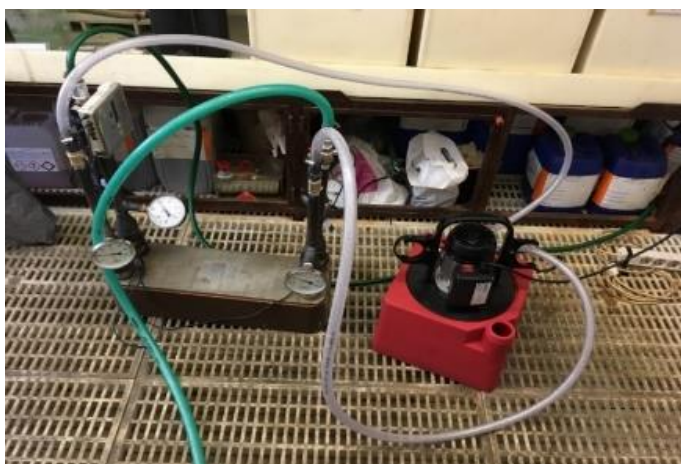
Obr. 4. Zapojení tepelného výměníku do čistícího okruhu [4].
