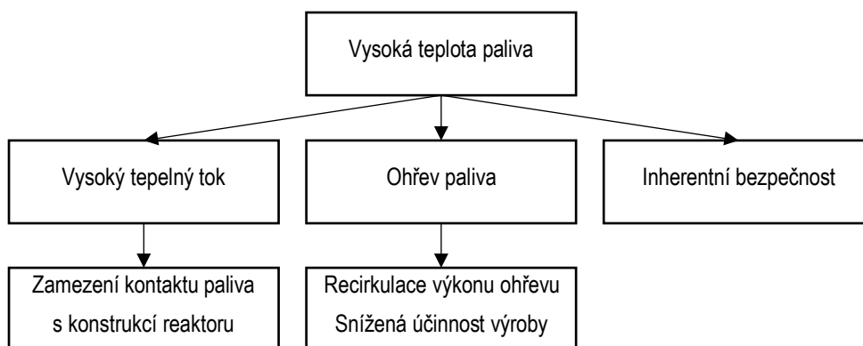
Obr. 3. Zjednodušený strom kauzálních vztahů vysoké teploty paliva.
