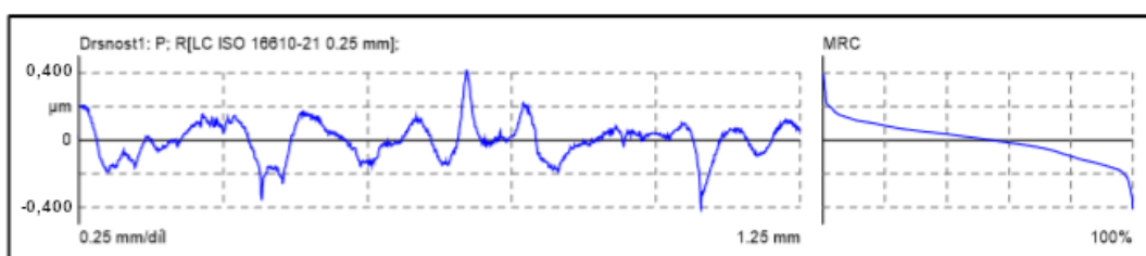
Obr. 28: Charakter povrchové drsnosti u termicky oxidovaného vzorku TN
