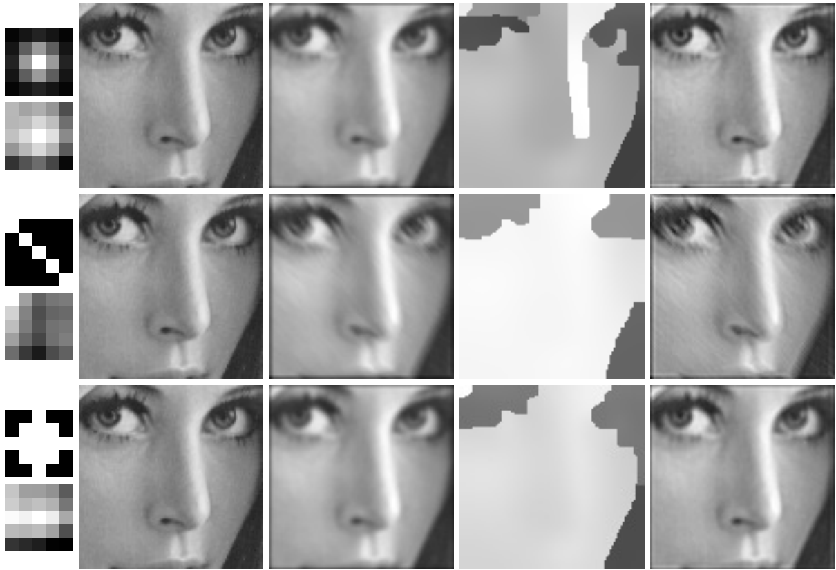
Obrázek 3.5: Výsledky pro ELBO-diag algoritmus (algoritmus (3)) a SNR 40dB. V prvním řádku jsou uvedeny výsledky pro gaussovské rozostření, v druhém pro rozmazání lineárním pohybem a v třetím pro špatné zaostření. V každém řádku je na levé straně nahoře ukázáno původní jádro, pod ním je jeho odhad. Následuje zleva původní čistý obraz, rozmazaný obraz s přidaným šumem, přímý výstup z algoritmu a výsledek neslepé dekonvoluce.
