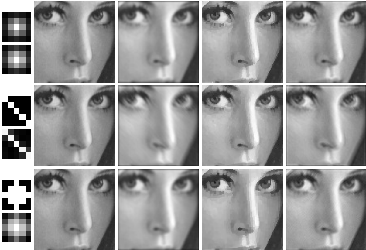
Obrázek 3.9: Výsledky pro ELBO-Vadam algoritmus (algoritmus 5) a SNR 40dB. V první řádce jsou uvedeny výsledky pro gaussovské rozostření, v druhém pro rozmazání lineárním pohybem a v třetím pro špatné zaostření. V každém řádku je na levé straně nahoře ukázáno původní jádro, pod ním je jeho odhad. Následuje zleva původní čistý obraz, rozmazaný obraz s přidaným šumem, přímý výstup z algoritmu a výsledek neslepé dekonvoluce.
