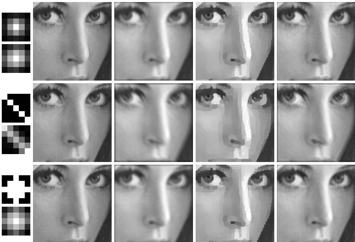
Obrázek 3.7: Výsledky pro ELBO-tdmat algoritmus (algoritmus (3) s tridiagonální \mathbf{S}_k ) a SNR 40dB. V první řádce jsou uvedeny výsledky pro gaussovské rozostření, v druhém pro rozmazání lineárním pohybem a v třetím pro špatné zaostření. V každém řádku je na levé straně nahoře ukázáno původní jádro, pod ním je jeho odhad. Následuje zleva původní čistý obraz, rozmazaný obraz s přidáním šumu, přímý výstup z algoritmu a výsledek neslepé dekonvoluce.
