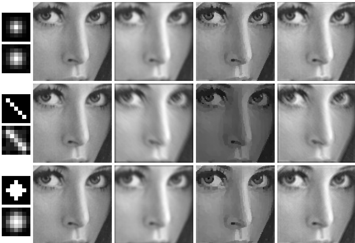
Obrázek 3.13: Výsledky pro ELBO-Vadam algoritmus (algoritmus (5)) při hledání větší PSF než byla původní, SNR je 40dB. V první řádce jsou uvedeny výsledky pro gaussovské rozostření, v druhém pro rozmazání lineárním pohybem a v třetím pro špatné zaostření. V každém řádku je na levé straně nahoře ukázáno původní jádro, pod ním je jeho odhad. Následuje zleva původní čistý obraz, rozmazaný obraz s přidaným šumem, přímý výstup z algoritmu a výsledek neslepé dekonvoluce.
