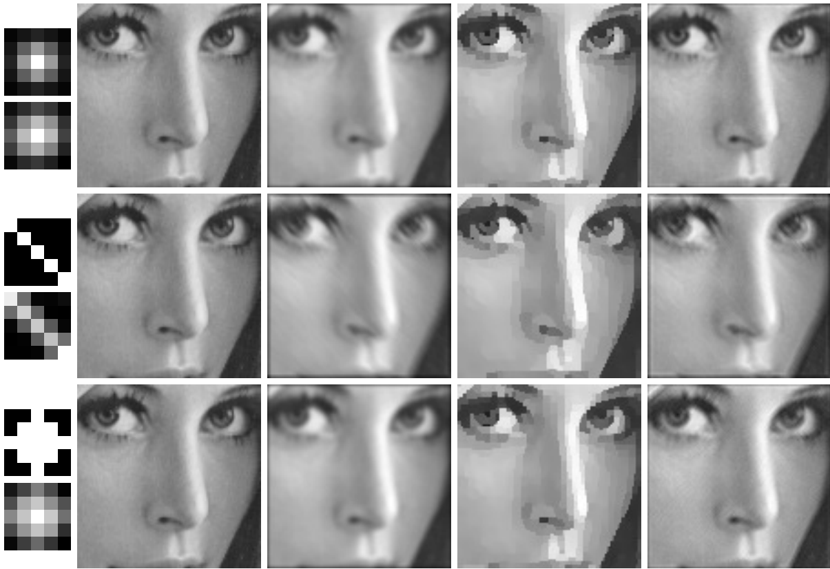
Obrázek 3.6: Výsledky pro ELBO-diag algoritmus (algoritmus (3)) a SNR 40dB. V první řádce jsou uvedeny výsledky pro gaussovské rozostření, v druhém pro rozmazání lineárním pohybem a v třetím pro špatné zaostření. V každém řádku je na levé straně nahoře ukázáno původní jádro, pod ním je jeho odhad. Následuje zleva původní čistý obraz, rozmazaný obraz s přidáním šumem, přímý výstup z algoritmu a výsledek neslepé dekonvoluce..
