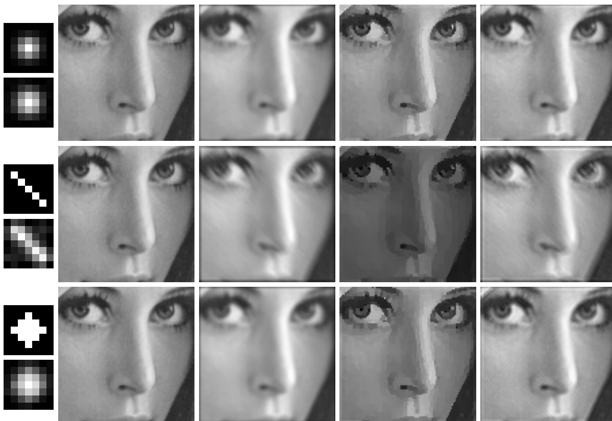
Obrázek 3.12: Výsledky pro IVB-full algoritmus (algoritmus (1)) při hledání větší PSF než byla původní, SNR je 40dB. V první řádce jsou uvedeny výsledky pro gaussovské rozostření, v druhém pro rozmazání lineárním pohybem a v třetím pro špatné zaostření. V každém řádku je na levé straně nahoře ukázáno původní jádro, pod ním je jeho odhad. Následuje zleva původní čistý obraz, rozmazaný obraz s přidáním šumu, přímý výstup z algoritmu a výsledek neslepé dekonvoluce.
