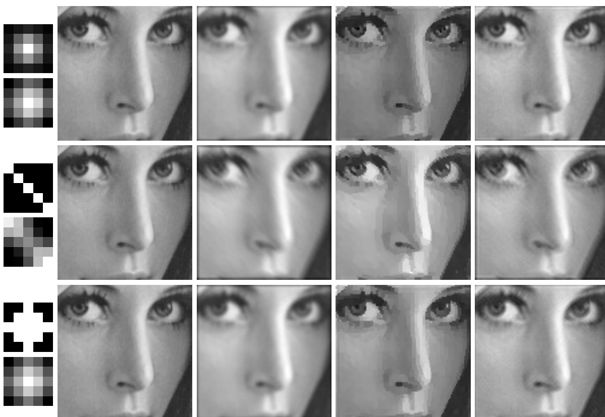
Obrázek 3.4: Výsledky pro IVB-diag algoritmus (algoritmus (2)) a SNR 40dB. V prvním řádku jsou uvedeny výsledky pro gaussovské rozostření, v druhém pro rozmazání lineárním pohybem a v třetím pro špatné zaostření. V každém řádku je na levé straně nahoře ukázáno původní jádro, pod ním je jeho odhad. Následuje zleva původní čistý obraz, rozmazaný obraz s přidáním šumem, přímý výstup z algoritmu a výsledek neslepé dekonvoluce.
