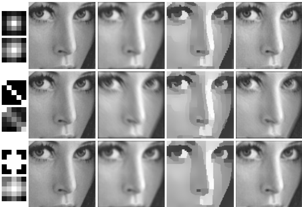
Obrázek 3.8: Výsledky pro ELBO-full25 algoritmus (algoritmus (3) s 25 vzorky v reparametrizačním triku) a SNR 40dB. V první řádce jsou uvedeny výsledky pro gaussovské rozostření, v druhém pro rozmazání lineárním pohybem a v třetím pro špatné zaostření. V každém řádku je na levé straně nahoře ukázáno původní jádro, pod ním je jeho odhad. Následuje zleva původní čistý obraz, rozmazaný obraz s přidaným šumem, přímý výstup z algoritmu a výsledek neslepé dekonvoluce.
