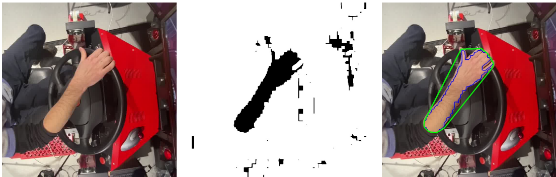
Obrázek 3.4: Detekce ruky podle barvy kůže. V levé části obrázku vidíme vstupní obrázek. Aplikací zpětné projekce kombinující pravděpodobnost z HSV a YCbCr prostoru a dilatace s křížovou maskou velikosti 5 \times 5 získáme binární reprezentaci obrázku uprostřed. Na posledním obrázku vidíme výstup, s vykreslenou největší konturou (modře) a jejím konvexním obalem (zeleně) na vstupním obrázku.
