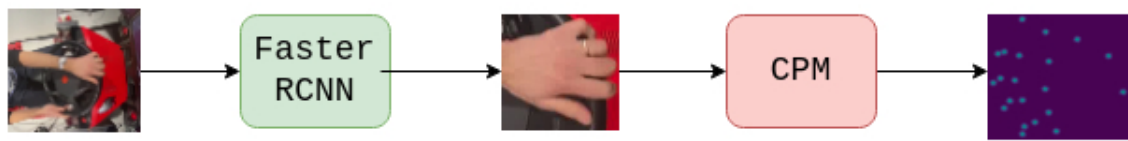
Obrázek 4.4: Schéma architektury odhadující 2D klíčové body. Na vstupu dostaneme obrázek, na kterém je pomocí Faster RCNN detekovaná ruka. Ruku ořízneme a pomocí CPM dostaneme teplotní mapy polohy klíčových bodů.
