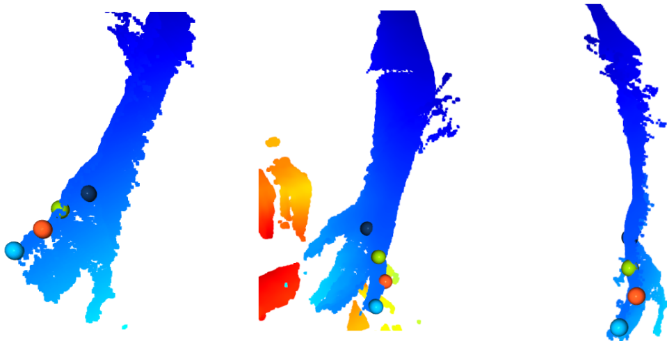
Obrázek 4.3: Práce v námi implementovaném softwaru pro anotaci 3D klíčových bodů. Barevné koule označují klíčové body. Na obrázku je jedna ruka ze tří různých úhlů pohledu.
