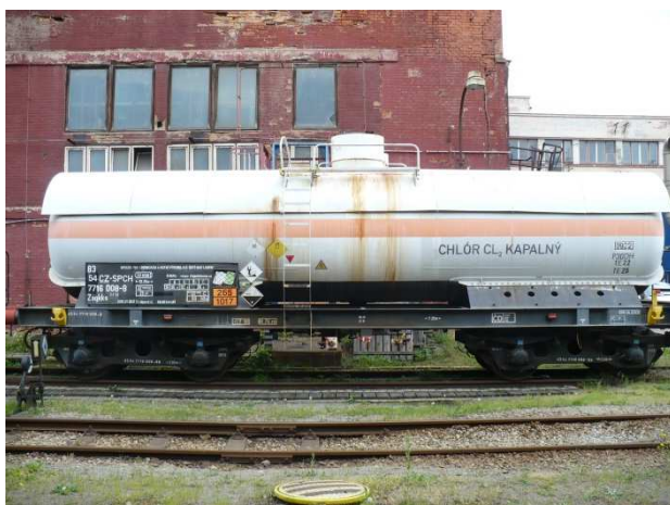
Obrázek 12 - Kotlový vůz na kapalný chlor v areálu Spolchemie a jeho nákres (foto Zdeněk Kadlec).
