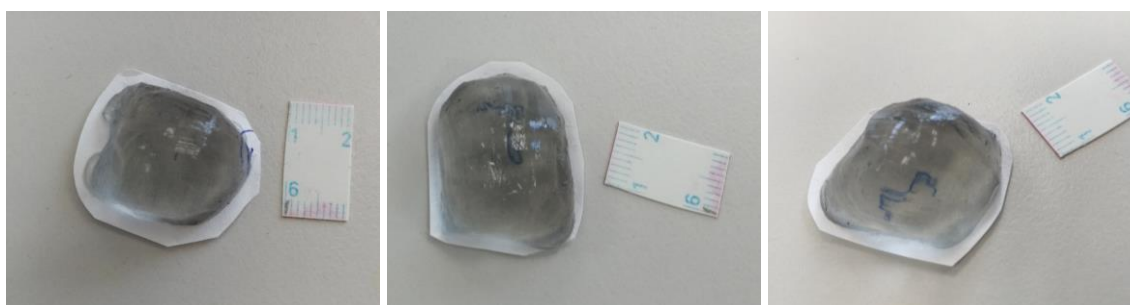
Obr. 5.56: Fotografie želatinových konizátů, které vznikly kličkou pohybující se v rámci vyříznuté trajektorie odpovídající SW modelům ideálních trajektorií.
