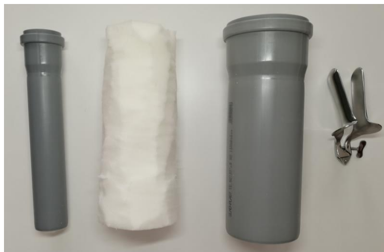
Obr. 4.7: Jednotlivé součásti, ze kterých byl fantom/simulátor vytvořen.
