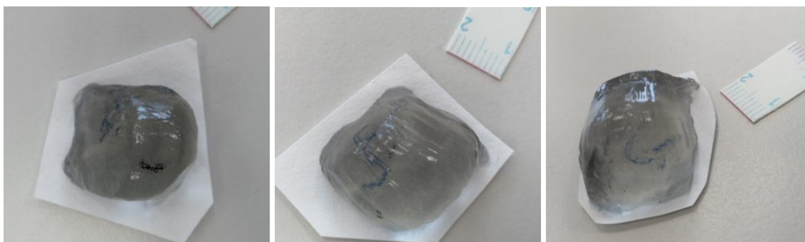
C.2: Fotografie želatinových konizátů, které vznikly kličkou pohybující se v rámci vyříznuté trajektorie odpovídající SW modelům optimálních trajektorií.
