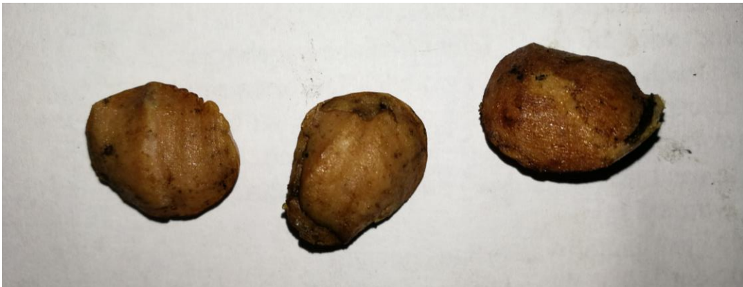
Obr. 5.33: Modely konizátů vzniklé referenčními tahy elektrochirurgickou kličkou v párcích, které odpovídají skutečným konizátům.
