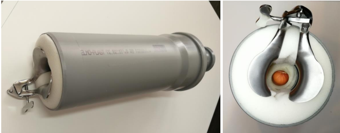
Obr. 5.37: Vlevo fotografie celého sestaveného simulátoru z odpadních trubek, molitanu a gynekologických zrcadel, vpravo pohled na simulovaný děložní čípek, který je upevněný v malé odpadní trubce a na vzniklé operační pole, ve kterém byly prováděny tahy modelem kličky.
