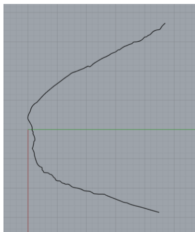
Obr. 5.51: Vlevo graf zrekonstruované trajektorie kličky z druhého simulátoru, vpravo model reálné trajektorie, po které se klička pohybovala.
