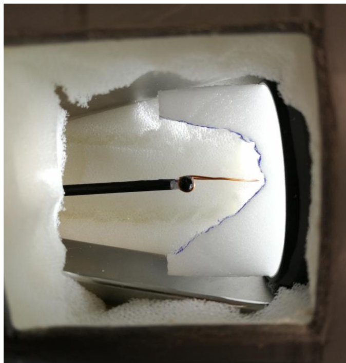
Obr. 5.46: Pohled do simulátoru operačního pole při provádění tahů modelem klíčky po vyřezaných trajektorích.
