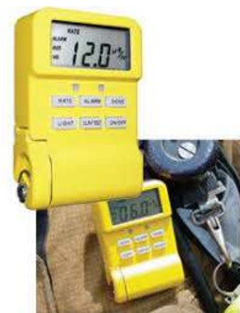
Obrázek 38: Zásahový dozimetr URAD 115 (Laurus systems c2020)
