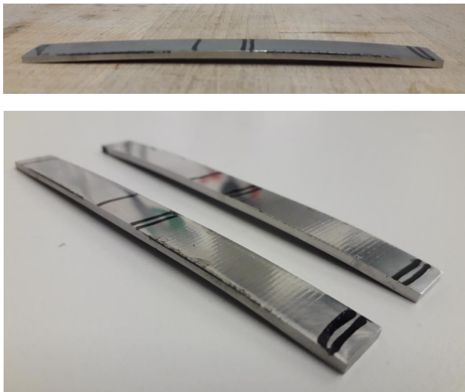
Obrázek 6.3: Obdélníkové vzorky prohnuté vlivem LSP metody
