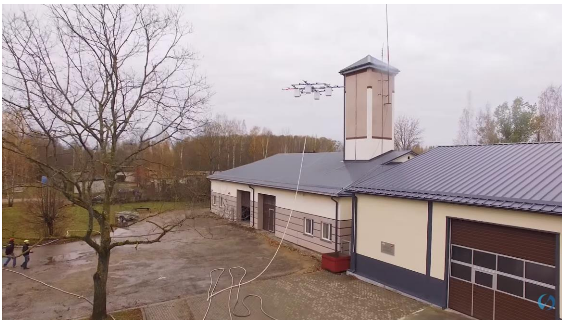
Obrázek 14 - UA napájen hasební látkou [25]
