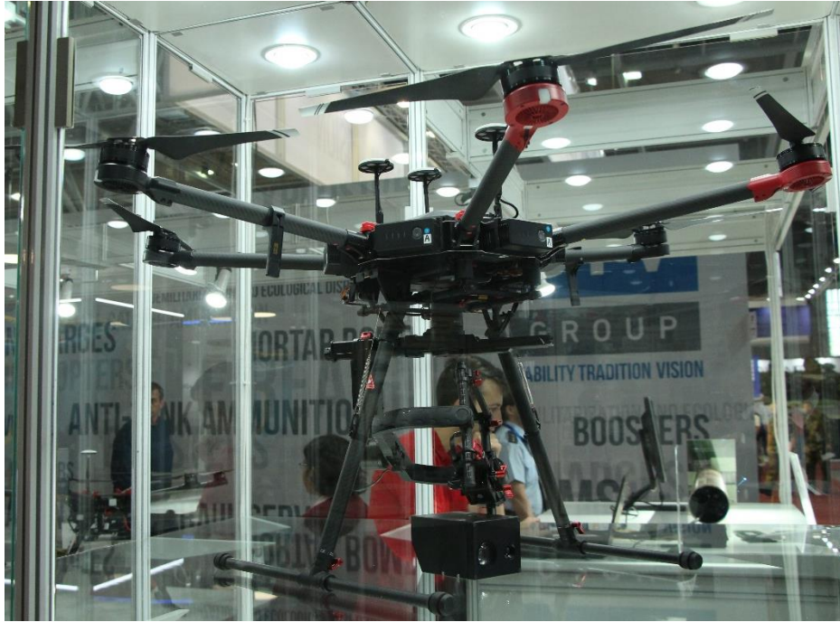
Obrázek 5 - UA VTOL hexakoptéra [zdroj vlastní]
