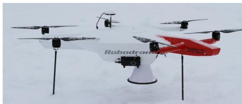
Obrázek 13 - Bepilotní letadlo s megafonem [22]
