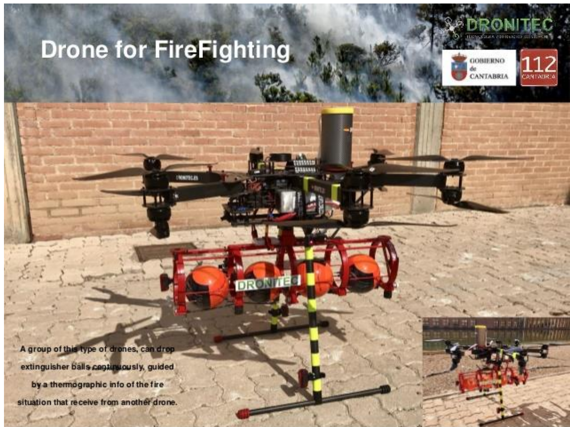
Obrázek 16 - UA osazen "protipožárními koulemi" [28]
