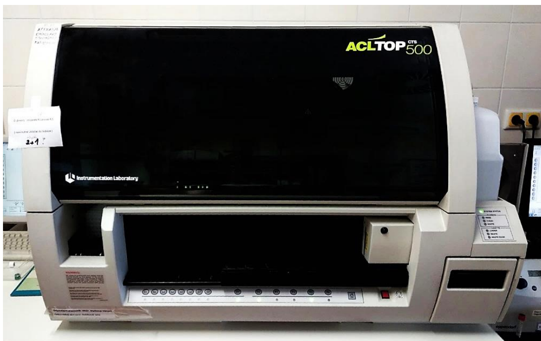
Obrázek 11 – Automatický koagulometr s optickou detekcí ACL TOP family 500 CTS (IL) [vlastní zdroj]
