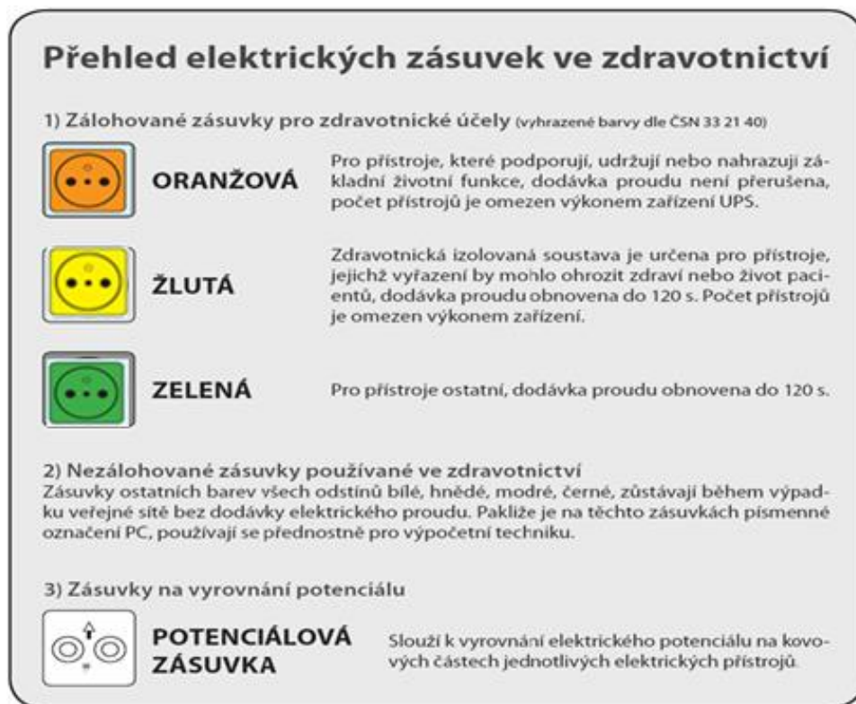
Obrázek 7 Přehled elektrických zásuvek ve zdravotnictví [37]
