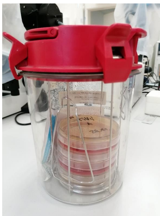
Obrázek 5: Uzavřený anaerostat s pūdami a s vloženým generátorem plynů Anaerocult® C (Natálie Klusová 2021).
