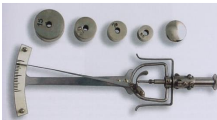
Obrázek 2 Schiötzův impresní tonometr [5]
