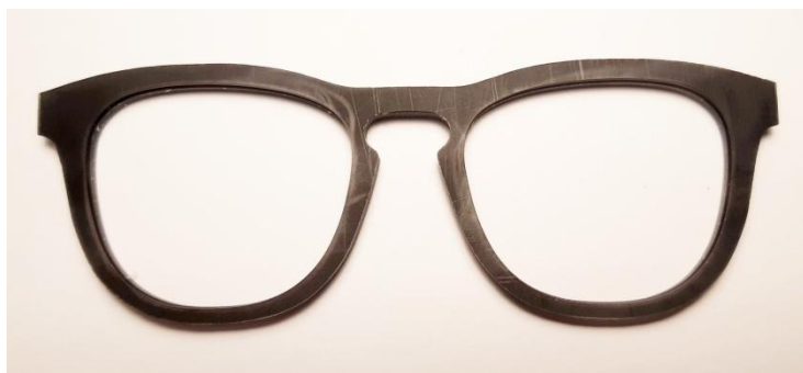
7-4 Vyfrézovaný základní tvar obruby
