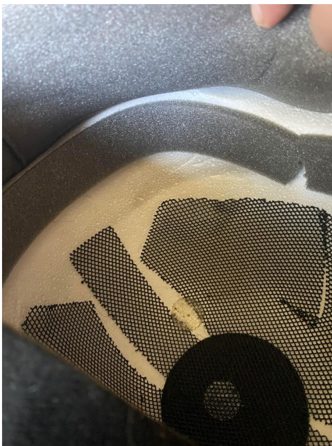
Obrázek 7 - poškození helmy po pádu (archiv autora)
