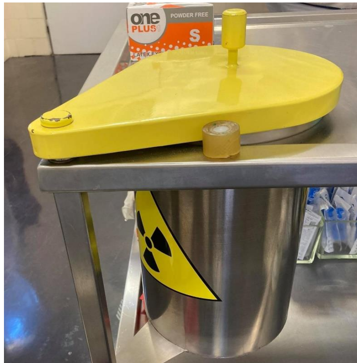
Obrázek 10 – Stínící nádoba na kontaminované pomůcky v aplikační místnosti
