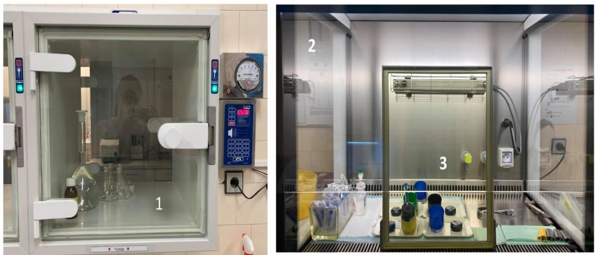
Obrázek 8 - 1. materiálová propust', 2. digestoř, 3. stínící štít na ochranu personálu
