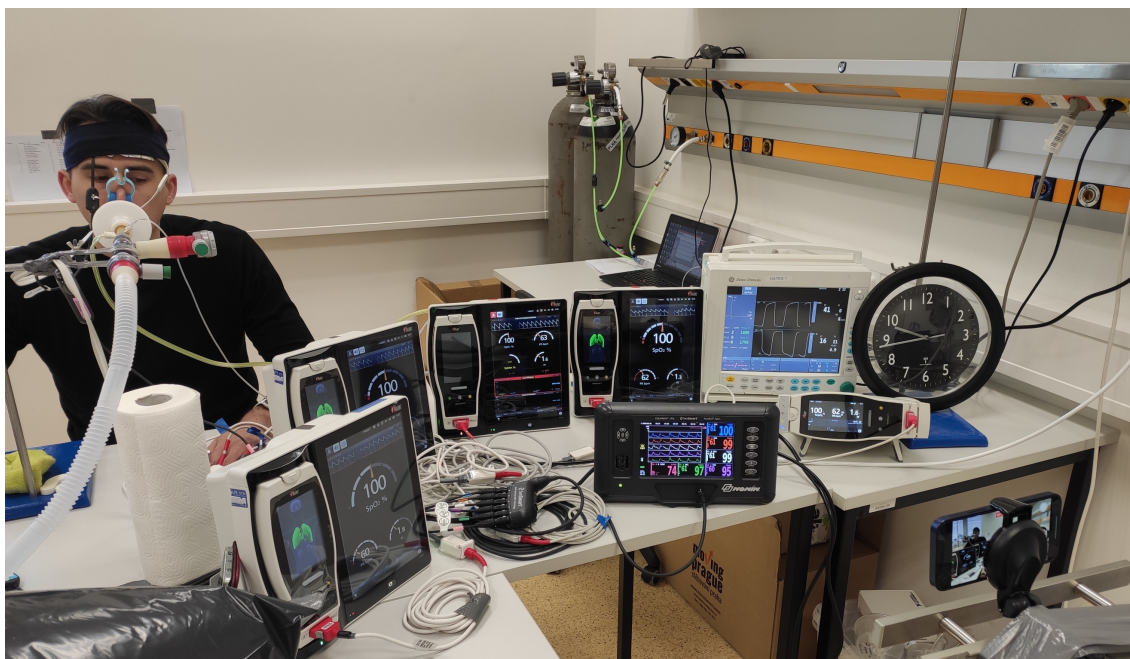
Obr. 4.3: Experimentální pracoviště s využívanými přístroji Root, Radical 7, SenSmart Model X-100 a Datex Ohmeda S/5.
