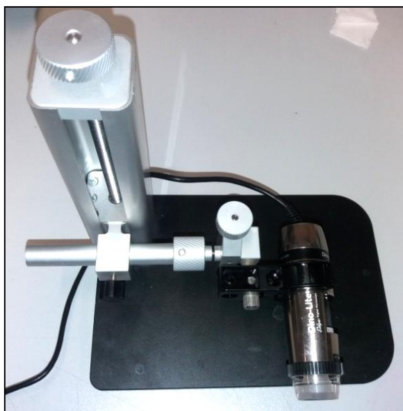
Obrázek 4.4: Mikroskopický kamerový systém Dino-Lite. Foto: autor.
