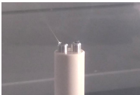
Obrázek 4.2: Detail proudu polymeru, tryskajícího z emitoru. Foto: autor.
