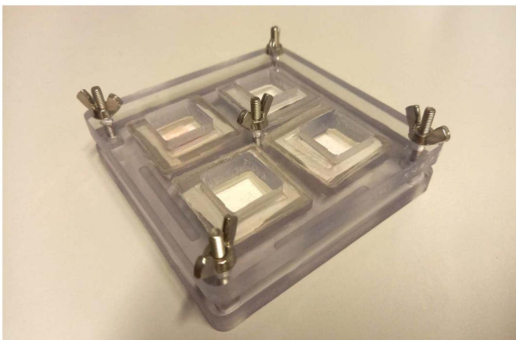
Obrázek 5.7: Vytištěná kultivační komora se vzorky. Foto: autor.
