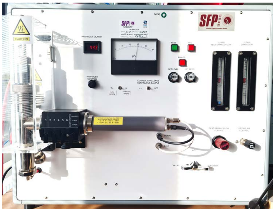
Obrázek 4.4: Plamenový fotometr typu 1275 od výrobce S.F.P. Services Ltd [autor]
