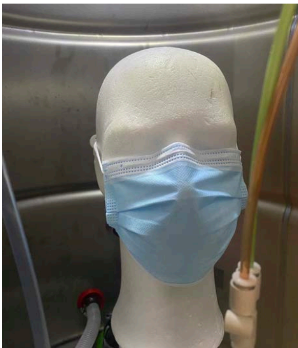
Obrázek 6.4: Sheffieldská hlava se zdravotnickou obličejovou maskou připravena v měřicí nádobě pro měření dle nového postupu měření [autor]
