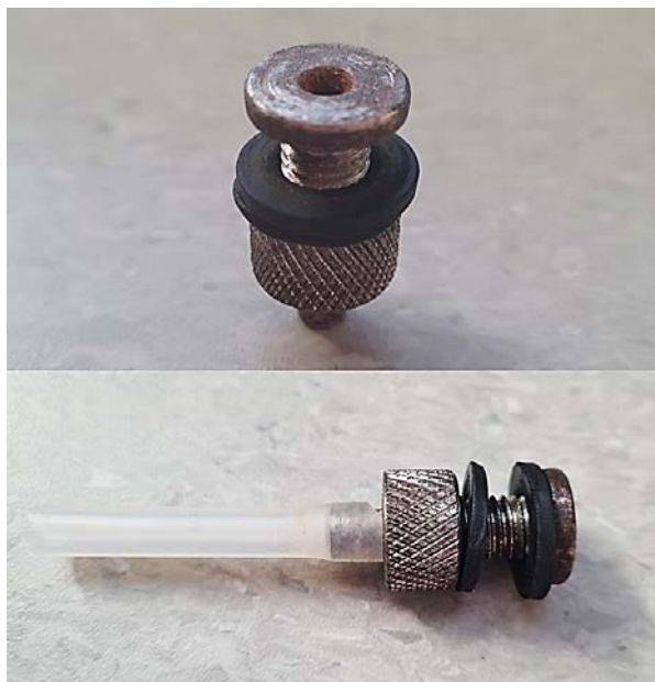
Obrázek 4.6: Sonda pro odběr vzorku z dýchací zóny a pro měření tlaku [autor]
