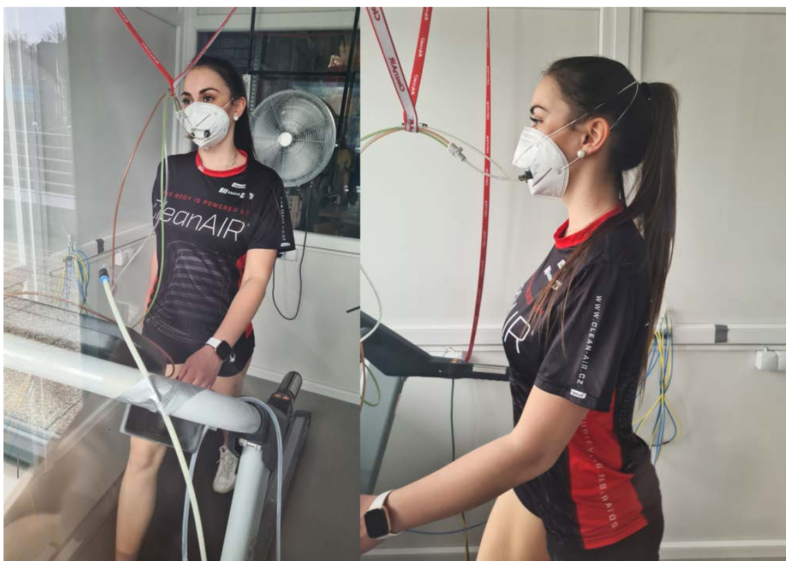
Obrázek 5.1: Subjekt vykonávající úkon chůze při testování filtrační polomasky třídy FFP3 v NaCl komoře [autor]
