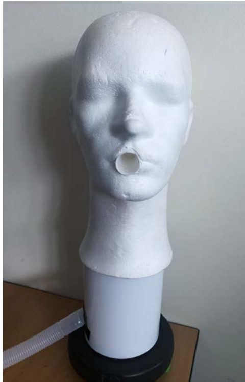
Obrázek 5.5: Zhotovená Sheffieldská hlava pro měření průniku v měřicí nádobě [autor]
