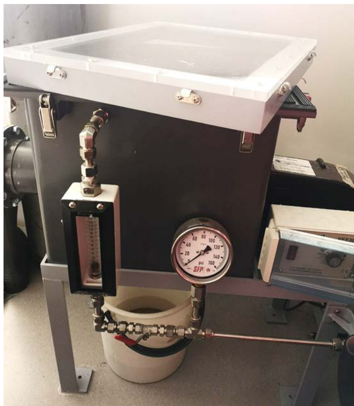
Obrázek 4.3: Generátor aerosolu chloridu sodného od výrobce S.F.P. Services Ltd. [autor]
