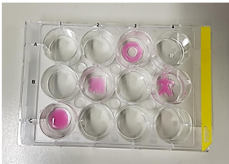
Obrázek 33: První série tisku do 12-ti jamkové kultivační destičky dispnzorem DISP1.
