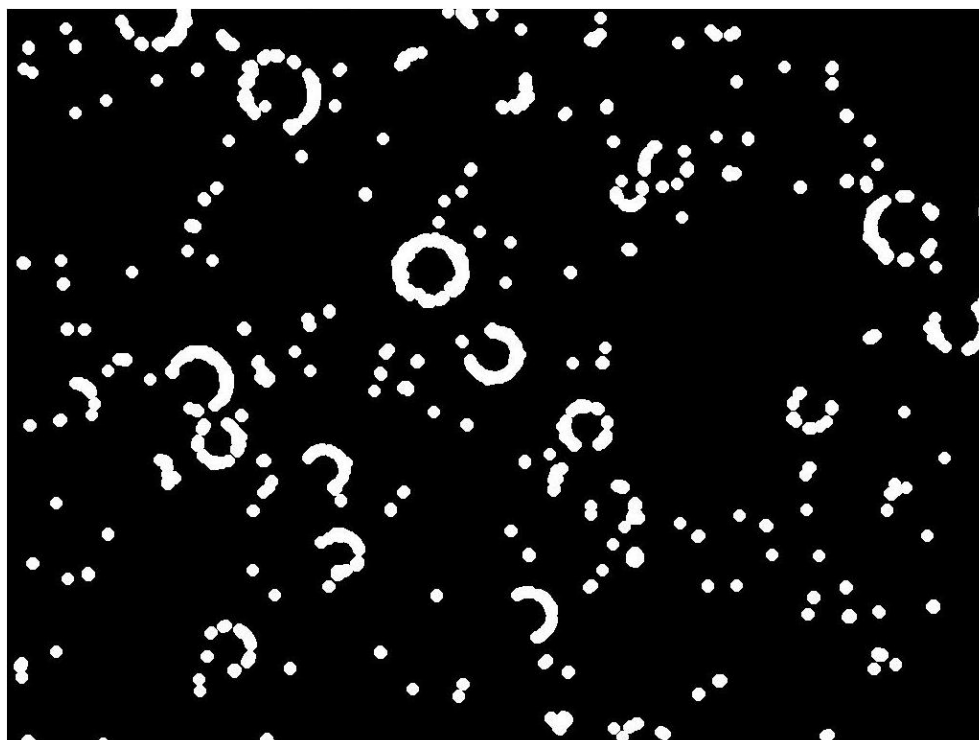
Obrázek 49: Předchozí snímek po provedení morfologické operace „otevření“. Zachování bublin a shluků.
