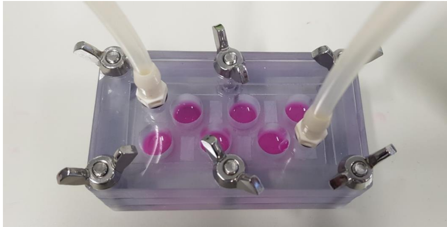
Obrázek 41: Kultivační komora s vloženým natisknutým krycím sklíčkem.
