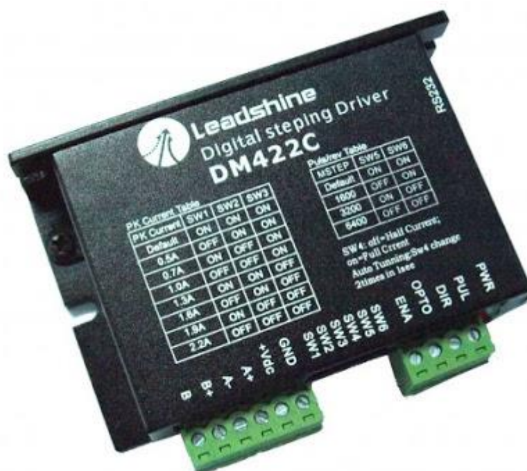
Obrázek 16: Ovladač krokových motorů DM422C. Převzato z (41)
