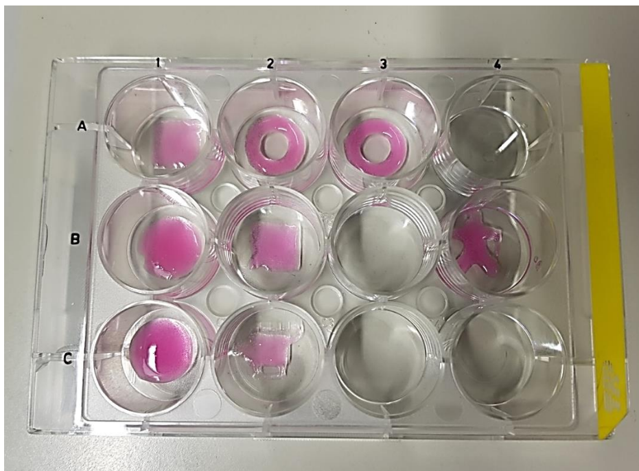
Obrázek 36: Výsledný testovací výtisk do 12-ti jamkové kultivační destičky pomocí dispenzoru DISP1.
