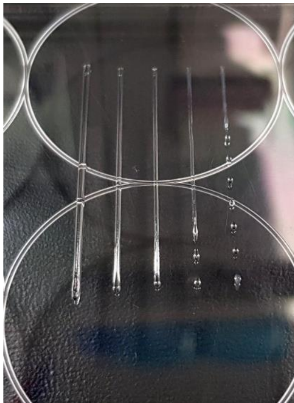
Obrázek 7: Ukázka kalibračního výtisku. Vadné dvě tištěné čáry zprava byly z grafického zhodnocení vyřazeny kvůli nekonzistentnosti tisku.
