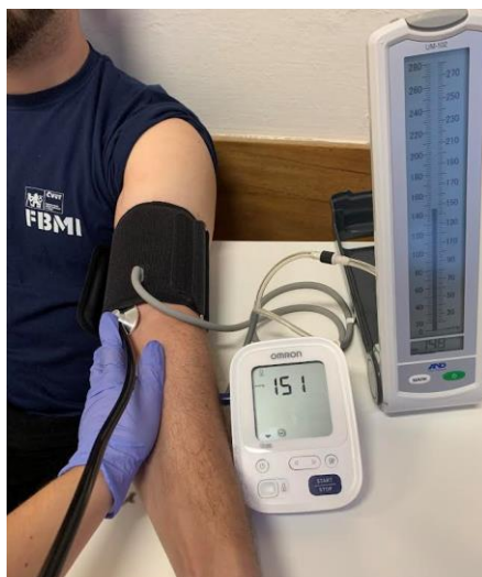
Obrázok 18: Ilustračná fotografia meracej sústavy pre znázornenie usporiadania aparatúry pri experimente. Pre meranie na probandoch bol využitý tonometer Omron M3.
