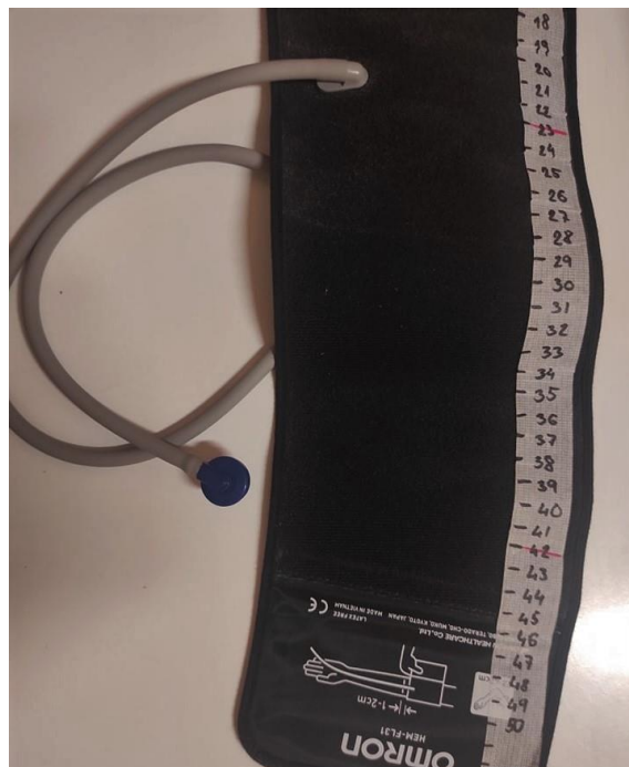
Obrázok 16: Manžeta Omron HEM-FL31 označená na obvode po centimetroch.
