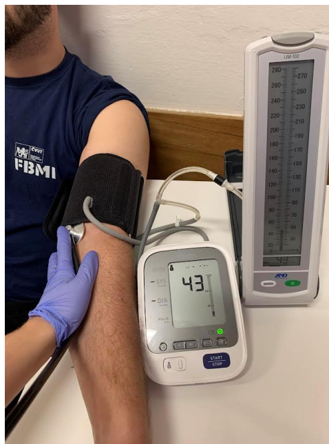
Obrázok 17: Ilustračná fotografia meracej sústavy pre znázornenie usporiadania aparatúry pri experimente. Pre meranie na probandoch bol využitý tonometer Omron M6 Comfort.
