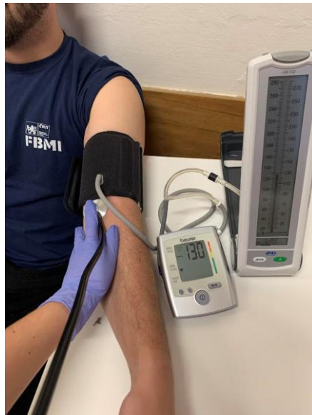
Obrázok 19: Ilustračná fotografia meracej sústavy pre znázornenie usporiadania aparatúry pri experimente. Pre meranie na probandoch bol využitý tonometer Beurer BM-35.
