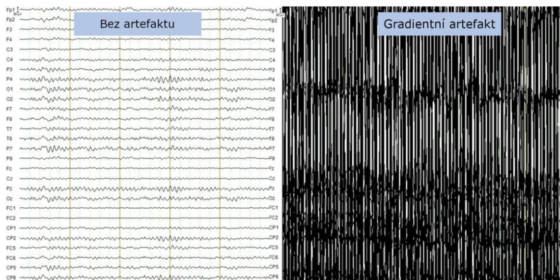
Obrázek 2.3: Ukázka EEG signálu bez gradientního artefaktu (vlevo) a EEG signálu překrytého gradientním artefaktem (vpravo). EEG signál byl naměřen při simultánním nahrávání EEG/fMRI. Převzato a upraveno z: [2].
