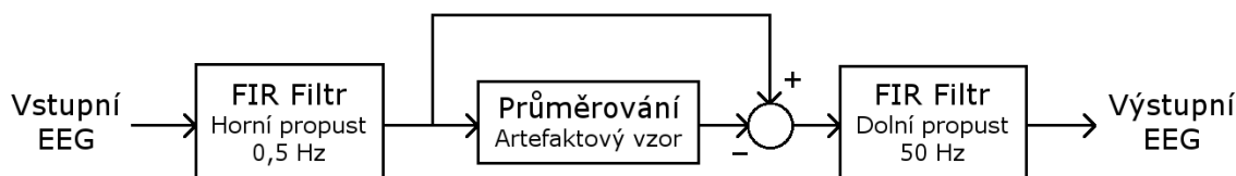
Obrázek 4.2: Blokové schéma navržené metody potlačení gradientního artefaktu bez použití interpolace.
