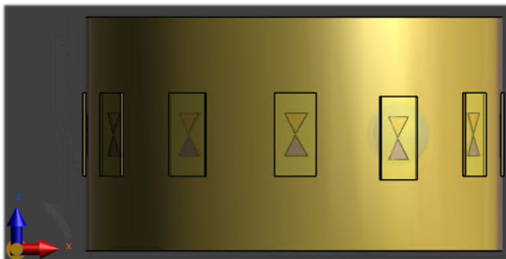
Obrázek 4.7 Model hlavy kruhové podstavy s výraznými hlavovými strukturami a systémem dvanácti antén po jeho obvodu. Pohled z boku.
