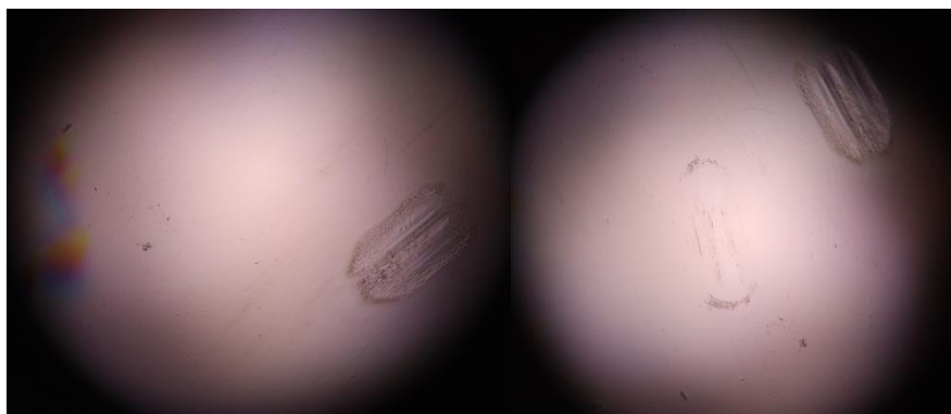
Obrázek 3.41: Kulička před (vlevo) a po (vpravo) měření BČ ZEISS LotuTec při zatížení 0,25 N, zvětšení 10x.
