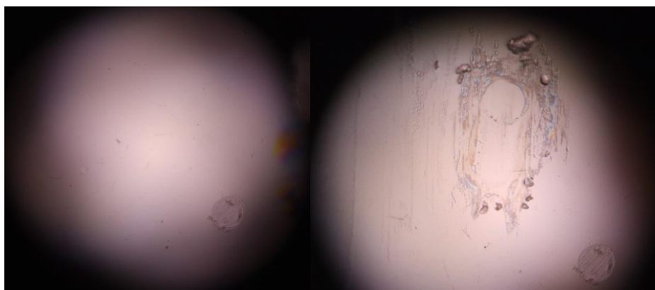
Obrázek 3.47: Kulička před (vlevo) a po (vpravo) měření BČ ZEISS DuraVision Platinum při zatížení 0,5 N, zvětšení 10x.
