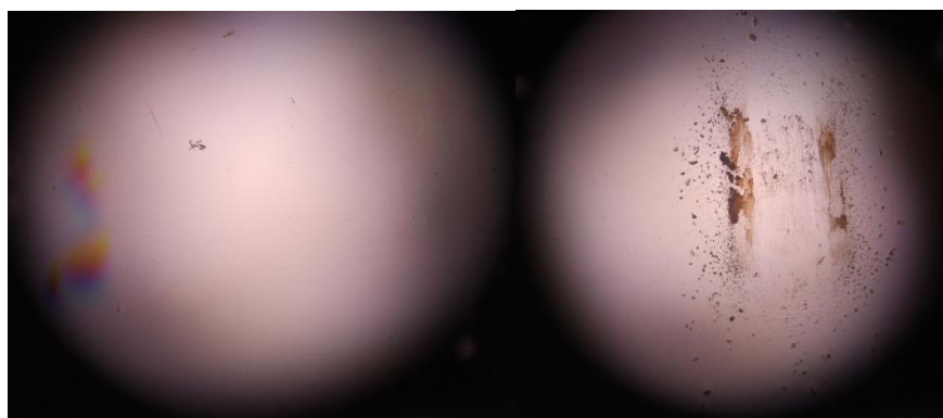
Obrázek 3.53: Kulička před (vlevo) a po (vpravo) měření BČ ZEISS BlueProtect při zatížení 1 N, zvětšení 10x.
