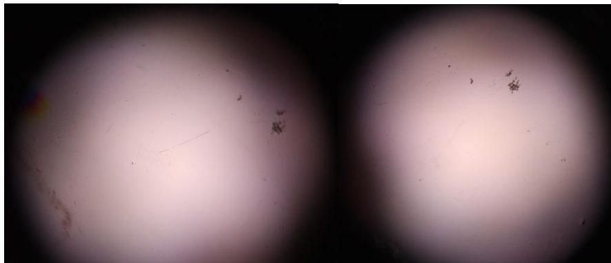
Obrázek 3.22: Kulička před (vlevo) a po (vpravo) měření BČ OMEGA Optix HMC při zatížení 0,25 N, zvětšení 10x.
