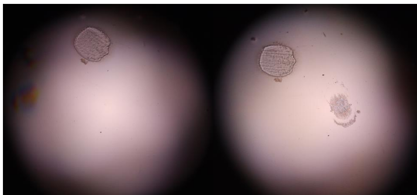
Obrázek 3.38: Kulička před (vlevo) a po (vpravo) měření BČ ZEISS - SUN Grey při zatížení 1 N, zvětšení 10x.
