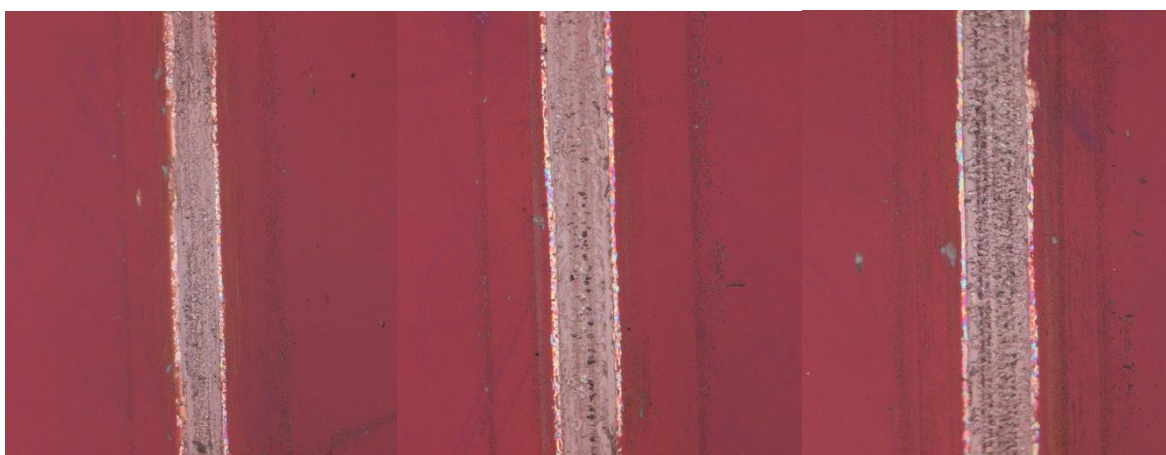
Obrázek 3.27: Vryp po zatížení 0,25 N; 0,5 N; 1N (zleva) u BČ OMEGA Optix Eye Drive, zvětšení 10x.
