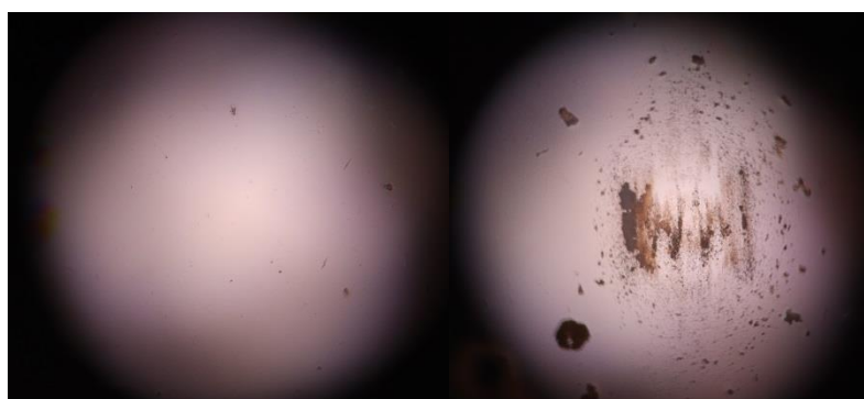
Obrázek 3.19: Kulička před (vlevo) a po (vpravo) měření BČ OMEGA Optix Super AR při zatížení 0,5 N, zvětšení 10x.
