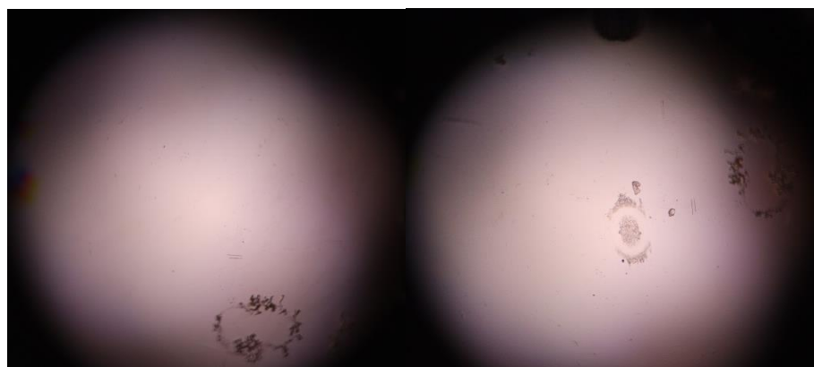
Obrázek 3.37: Kulička před (vlevo) a po (vpravo) měření BČ ZEISS - SUN Grey při zatížení 0,25 N, zvětšení 10x.
