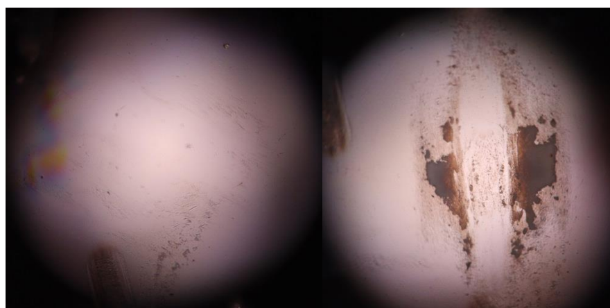
Obrázek 3.29: Kulička před (vlevo) a po (vpravo) měření BČ OMEGA Optix EyeDrive při zatížení 0,5 N, zvětšení 10x.
