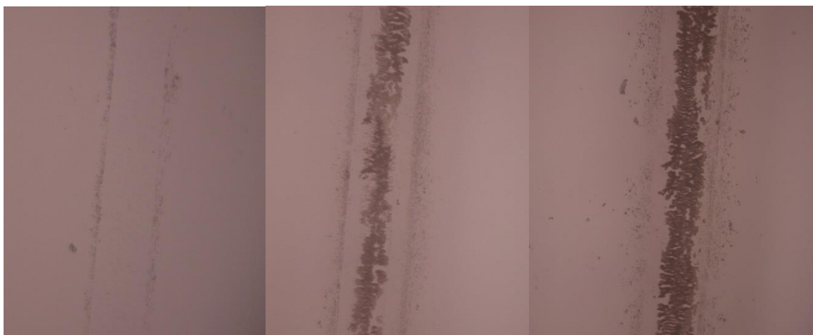
Obrázek 3.12: Vryp po zatížení 0,25 N; 0,5 N, 1 N (zleva) u BČ OMEGA Optix HC, zvětšení 10x.
