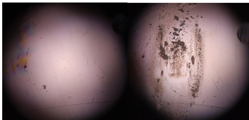
Obrázek 3.43: Kulička před (vlevo) a po (vpravo) měření BČ ZEISS LotuTec při zatížení 1 N, zvětšení 10x.
