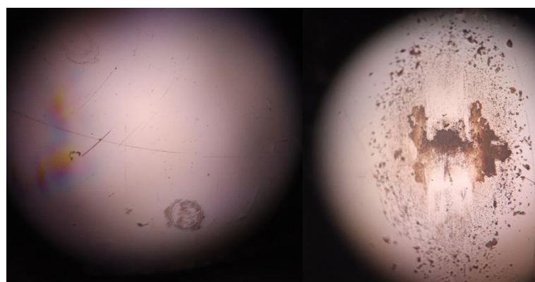
Obrázek 3.25: Kulička před (vlevo) a po (vpravo) měření BČ OMEGA Optix HMC při zatížení 1 N, zvětšení 10x.
