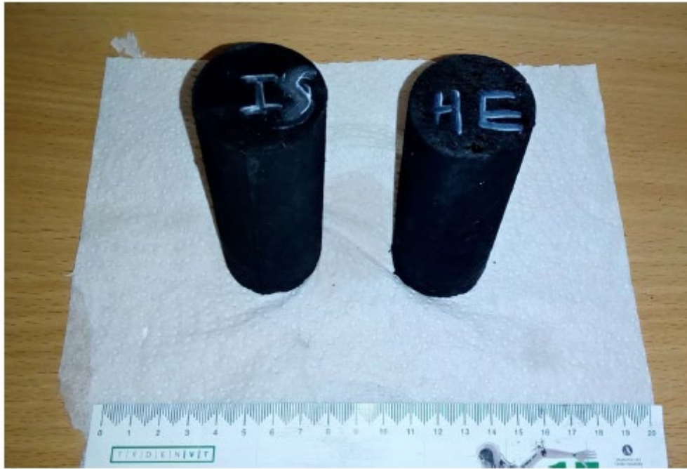
Obrázek 2.1 – Fantomy napodobující ischemickou a hemoragickou mozkovou příhodu bez důrazu na velikost a tvar, převzato z [6].
