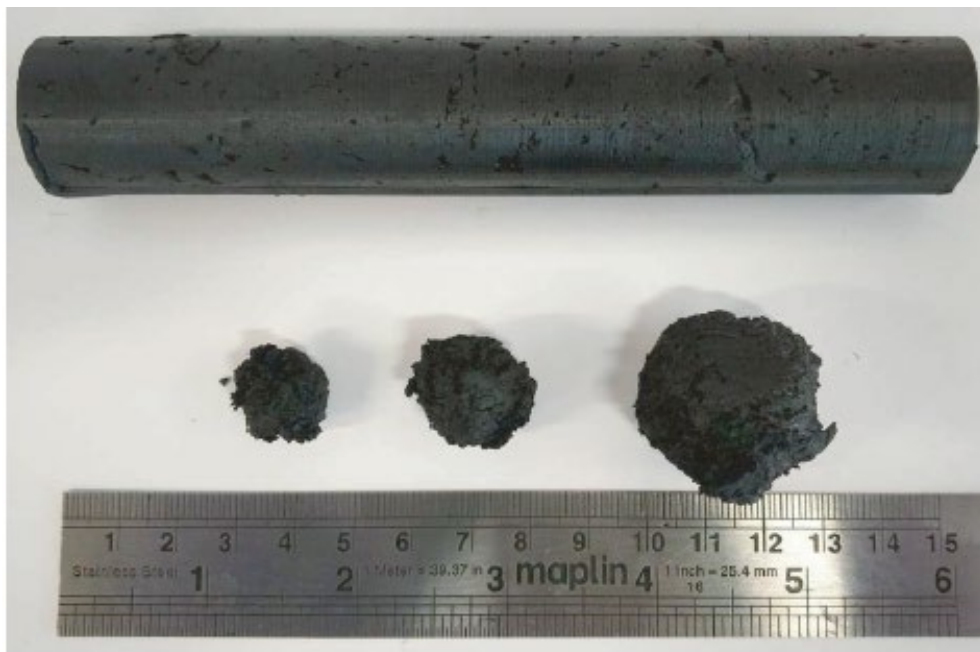
Obrázek 2.2 - Fantomy hemoragické cévní mozkové příhody, napodobující cévní mozkovou příhodu rozměry i tvarem, převzato z [2].
