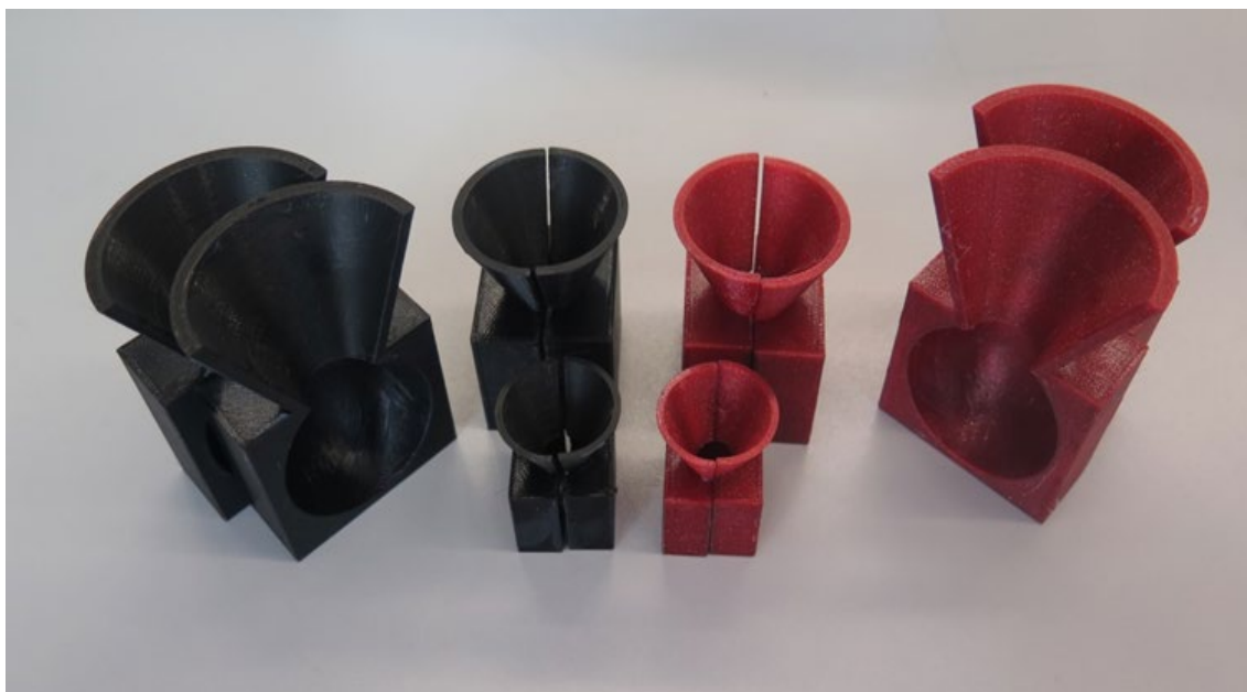
Obrázek 5.1 - Vytištěné formy - červené barvy jsou určeny pro výrobu fantomu hemoragické CMP a formy černé barvy jsou určeny pro výrobu ischemické CMP.
