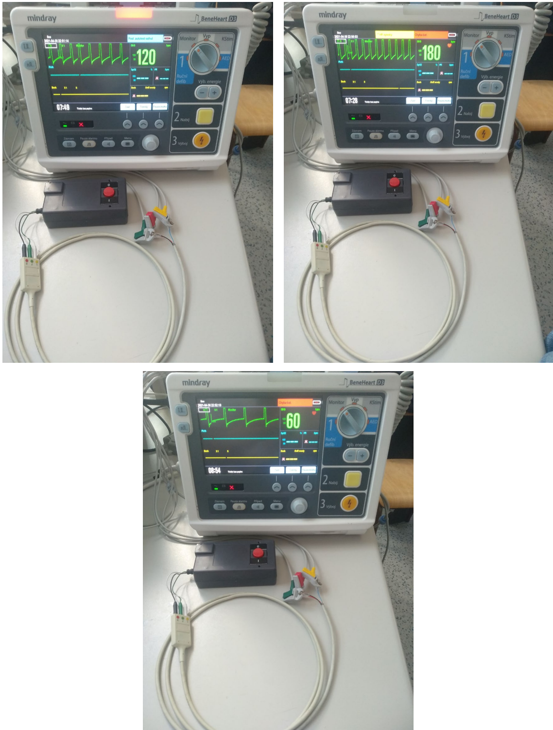
Obrázek 5.5: Připojení simulátoru na monitor životních funkcí BeneHeart D3
