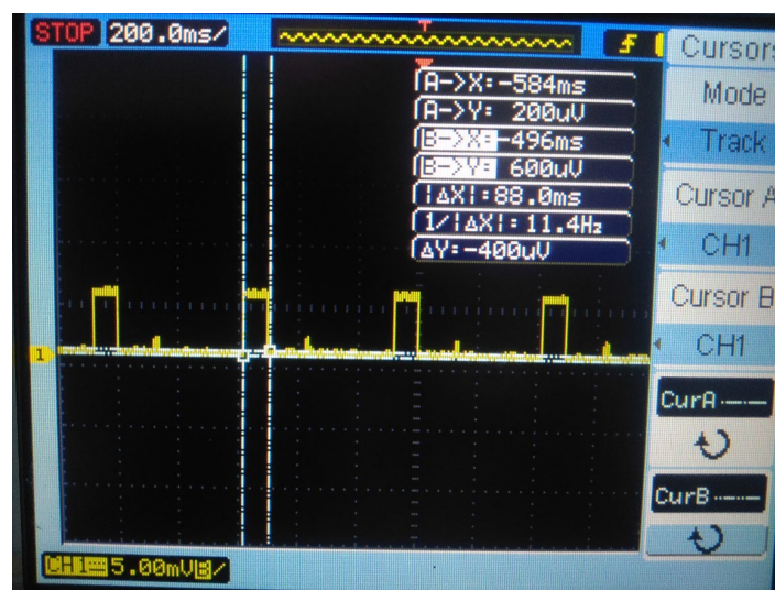
Obrázek 4.11: Ověření EKG simulátoru na osciloskopu
