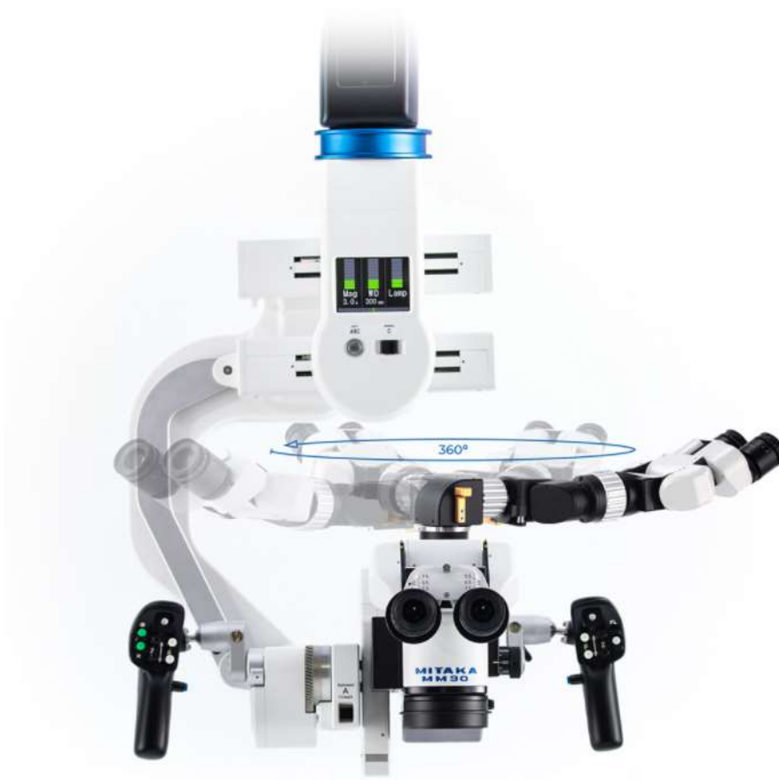
Obrázek 5.4 Znárodnění možné 360^\circ rotace asistenčního binokuláru [45]
