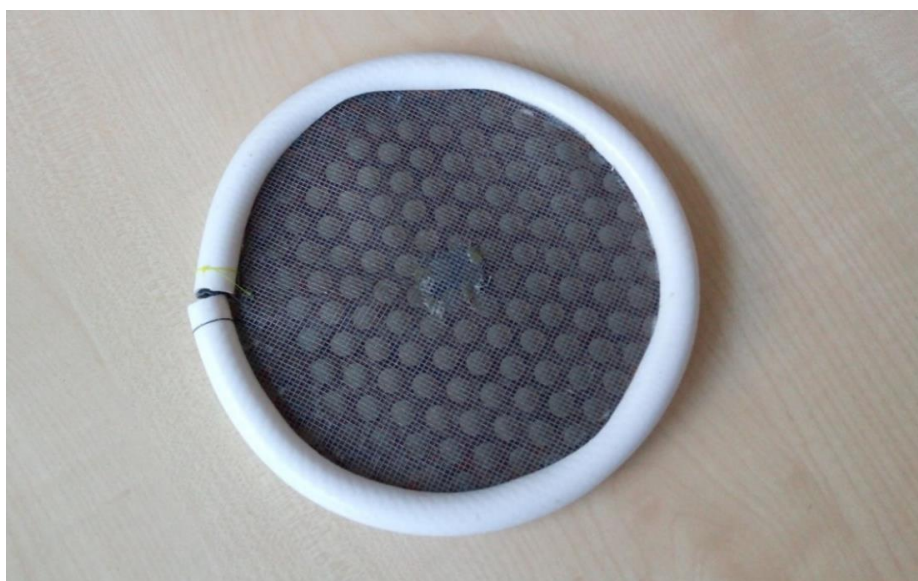
Obrázek 4.4: Síto do trychtýře, které vytvořilo dýchací kapsu o objemu 1 l
