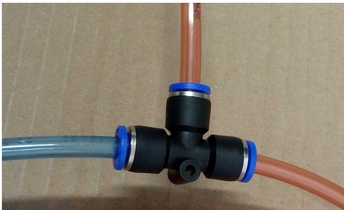
Obr. 4.4: Nástrčná spojka T PUT-6, která dělí přívod oxidu dusného z tlakové lahve
