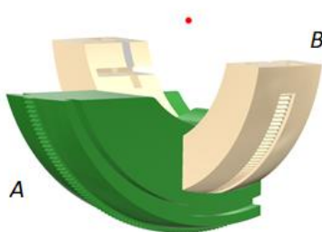
Obrázek 4.1:1: Půlkruhy zapuštěné v sobě, mající stejný bod otáčení – červený bod. Rotační díl A zajišťuje pitch, rotační díl B roll.
