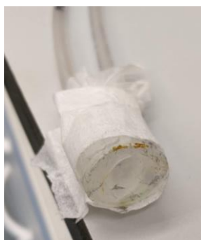
Obrázek 2.2:7: Obličejová maska pro laboratorní myš vyrobená z ustřižené injekční stříkačky a gumové rukavice
