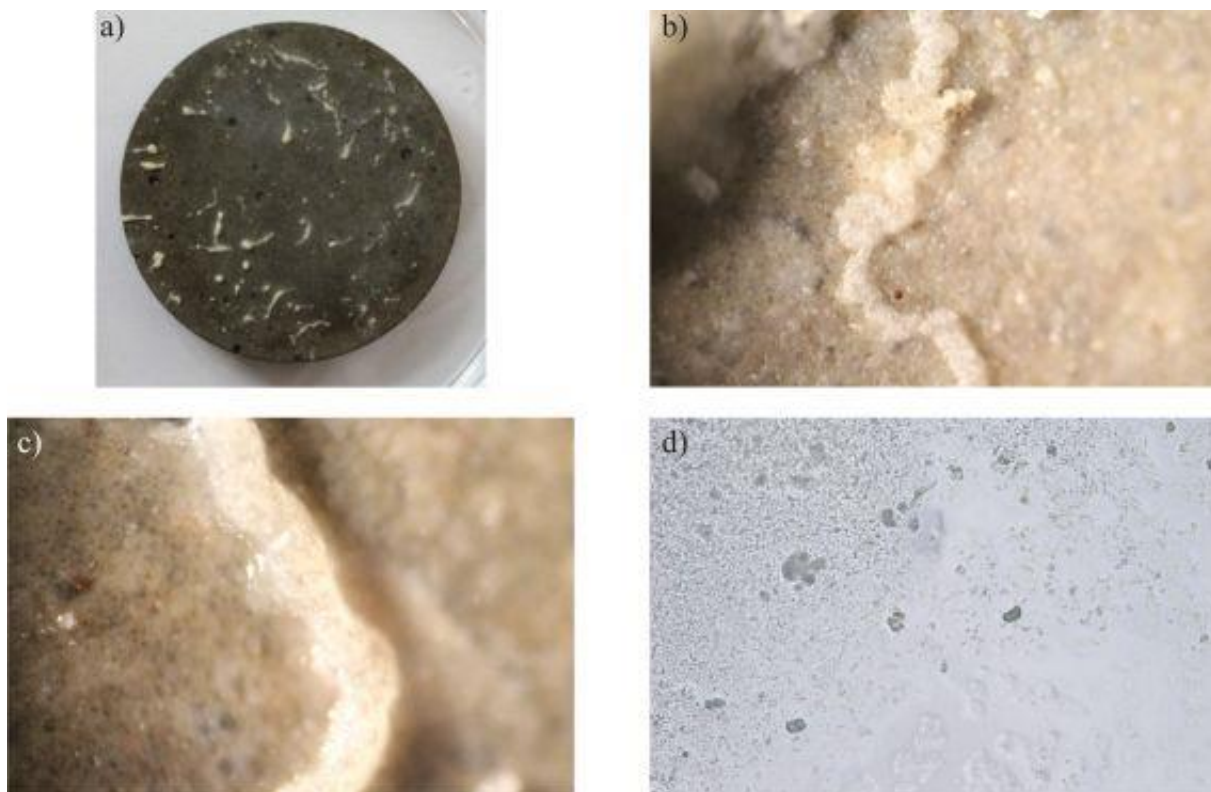
Obr. 26: Povrch zkušebních těles uchovávaných v médiu 253 (foto autorka)
