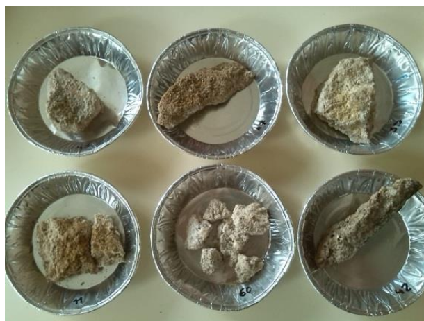
Obr. 6: Příklad odebraných vzorků pro měření vlhkosti gravimetrickou metodou (foto autorka)
