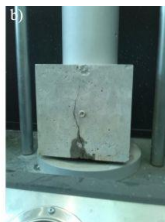
Obr. 43: Průsak zkušebními tělesy při provádění zkoušky (foto autorka) a) Zkouška 90 dní po betonáži, b) Zkouška 220 dní po betonáži
