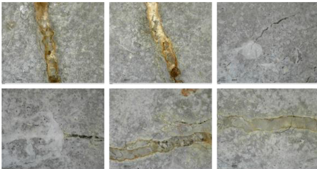
Obr. 71: Vybrané snímky z optického stolního mikroskopu, zvětšení 50x (foto Reiterman P.)
