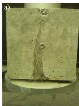
Obr. 43: Průsak zkušebními tělesy při provádění zkoušky (foto autorka) a) Zkouška 90 dní po betonáži, b) Zkouška 220 dní po betonáži
