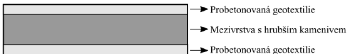
Obr. 50: Schéma řezu zkušebním tělesem
