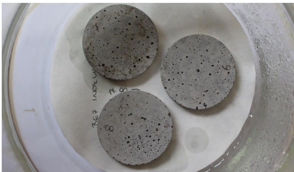
Obr. 35: Zkušební tělesa umístěná v exsikátoru, foceno 9. 7. 2018 (foto autorka)
