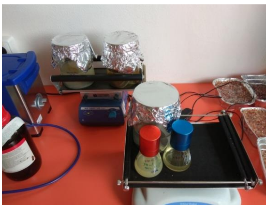
Obr. 19: Uchovávání zkušebních těles v roztocích (foto autorka)
