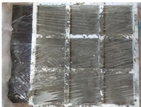
Obr. 57: Ošetřování zkušebních těles ve formě (foto autorka)
