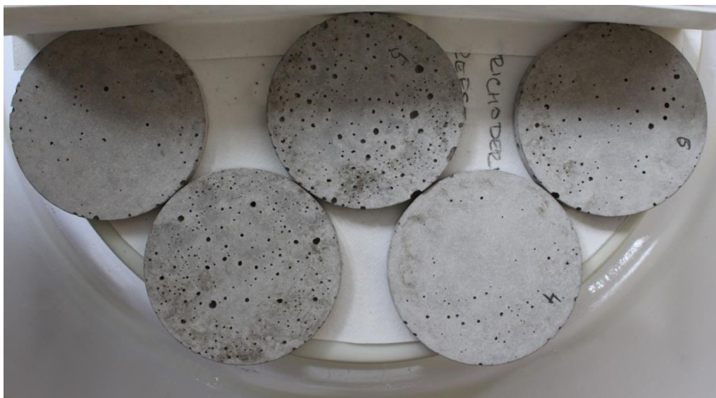
Obr. 33: Zkušební tělesa umístěná v exsikátoru, foceno 9. 7. 2018 (foto autorka)
