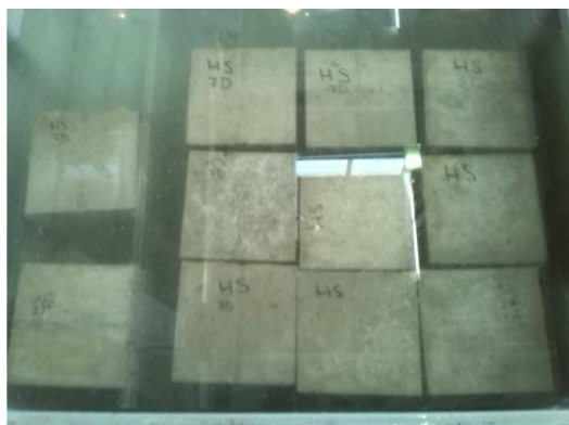
Uložení těles pod hladinou vody
