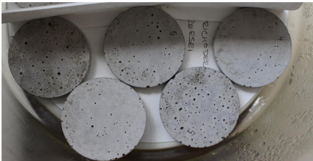
Obr. 32: Zkušební tělesa umístěná v exsikátoru, foceno 26. 6. 2018 (foto autorka)
