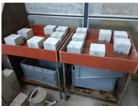
Obr. 47: Uložení zkušebních těles v nádržích se stabilní hladinou vody (foto autorka)
