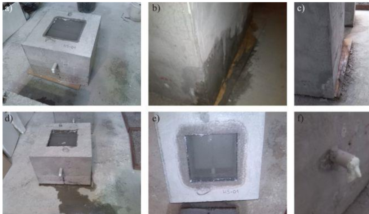
Obr. 12: Zkušební tělesa napuštěná vodou (foto autorka)
