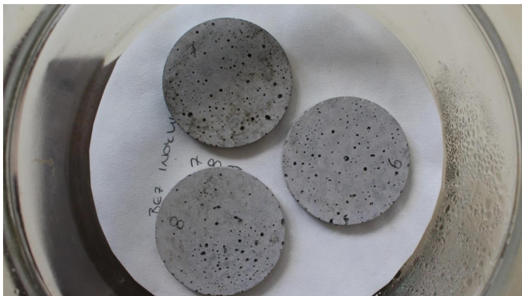
Obr. 34: Zkušební tělesa umístěná v exsikátoru, foceno 26. 6. 2018 (foto autorka)
