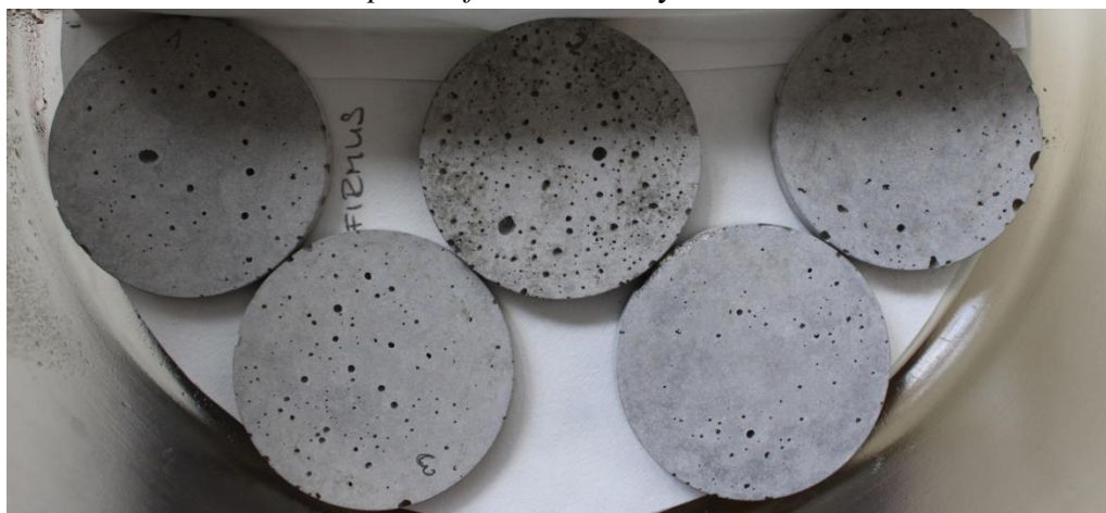
Obr. 29: Zkušební tělesa umístěná v exsikátoru, foceno 26. 6. 2018 (foto autorka)
