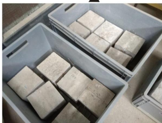
Uložení těles v přepravkách s konstantní hladinou vody
