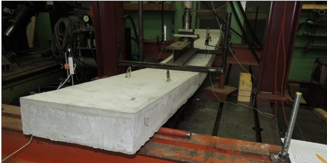
Obr. 108 Pohled na vzorek po dosažení MSÚ
