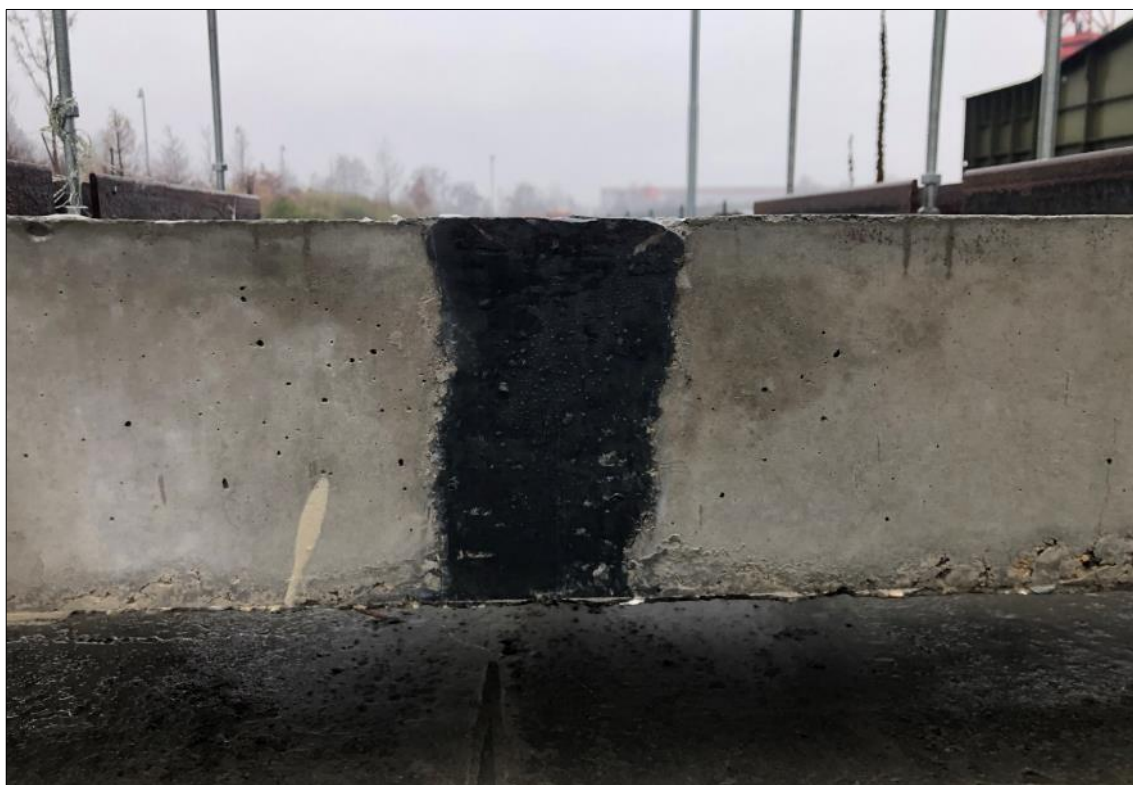
Obr. 119 Pohled na zatěžované desky – vzorek se spojem o šířce 80 mm
