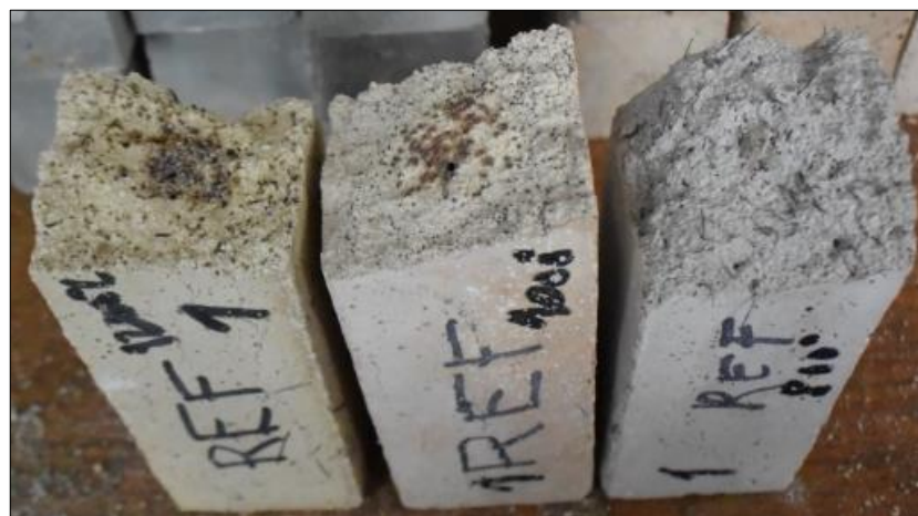
Obr. 50 Vzorky UHPFRC vystavené vysokým teplotám
