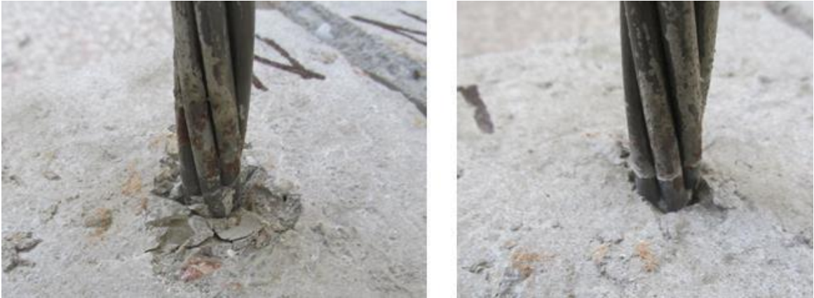
Obr. 99 Detail porušení vzorku z C40/50 bez protikorozní ochrany (vlevo), s protikorozní ochranou typu U (vpravo)
