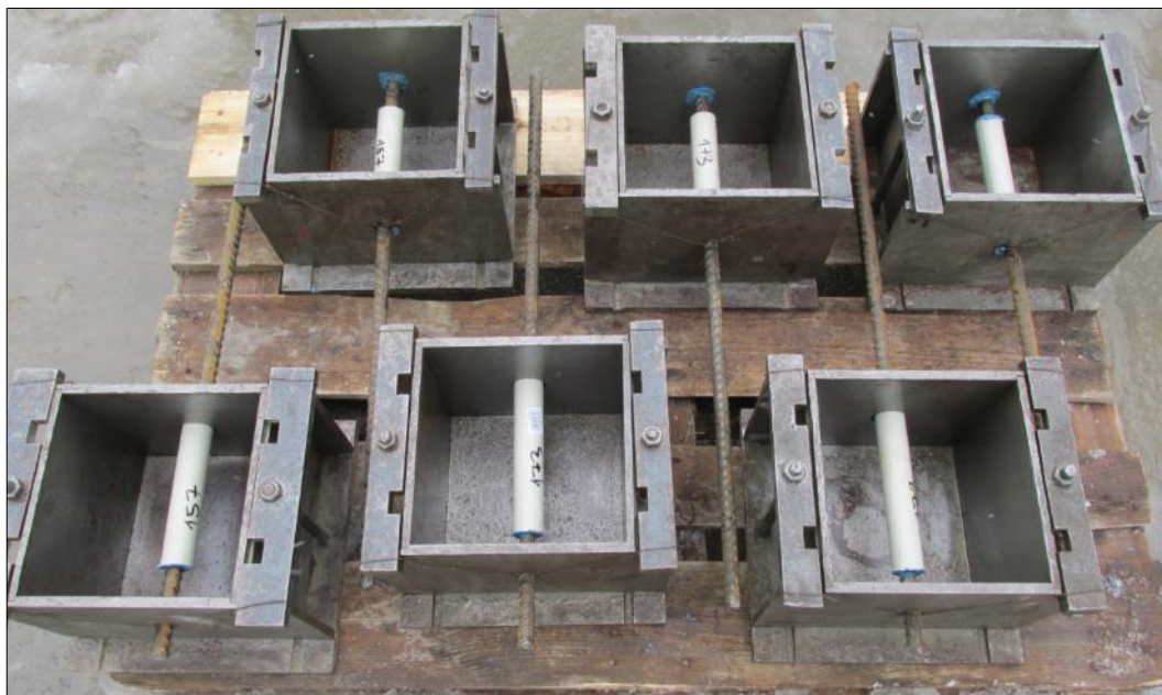
Obr. 71 Formy s připravenou výztuží
