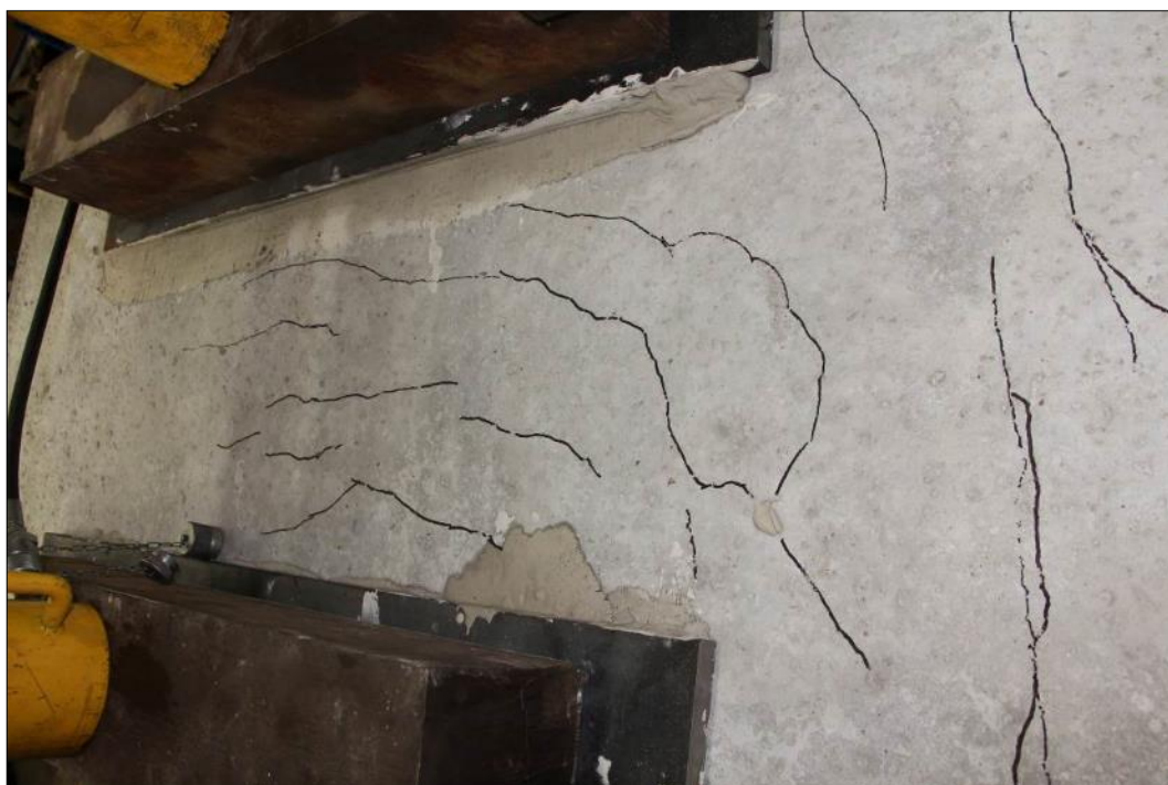
Obr. 143 Tvorba podélných trhlin v případě monolitické varianty
