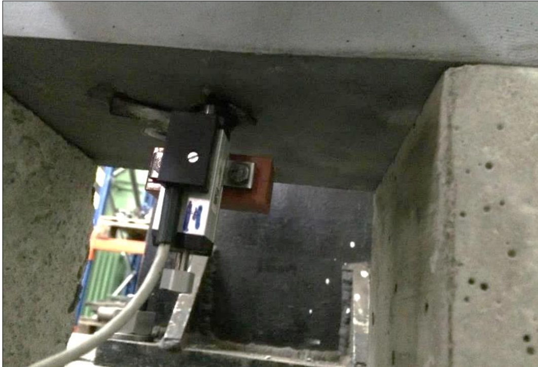
Obr. 76 Měření pokluzu na spodní části vzorku
