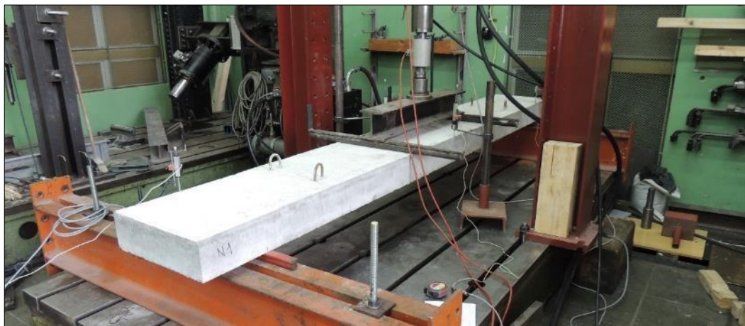
Obr. 106 Pohled na referenční nosník připravený na zkoušku
