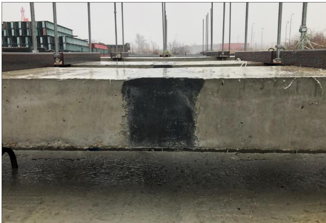
Obr. 118 Pohled na zatěžované desky – vzorek se spojem o šířce 140 mm
