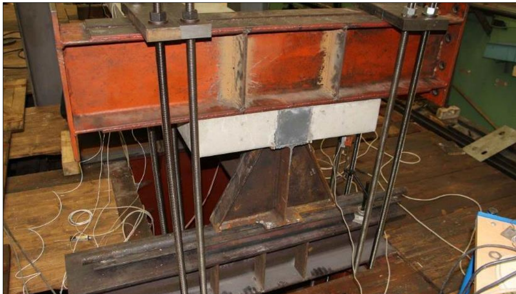
Obr. 139 Přitažení vetknuté části nosníku závitovými tyčemi
