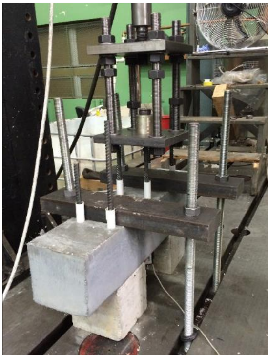
Obr. 74 Vytažení střední výztuže
