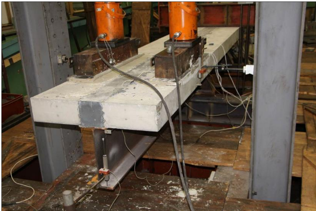
Obr. 141 Prefabrikovaná mostovka s UHPC spojem
