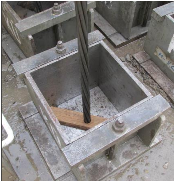
Obr. 43 Schéma výroby zkušební vzorku
