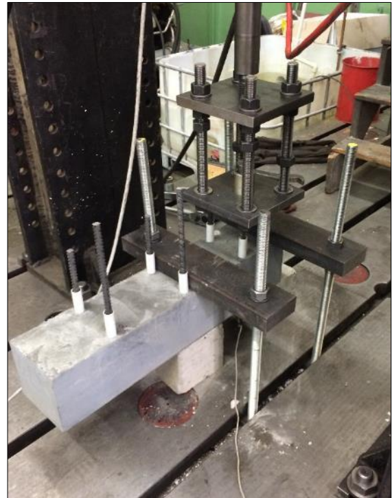
Obr. 75 Vytažení vnější výztuže
