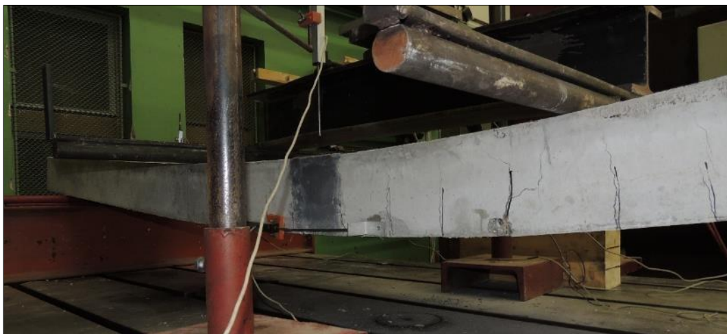
Obr. 111 Porovnání odezvy vzorků po cyklování až do dosažení únosnosti
