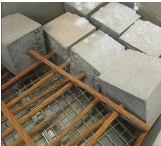
Obr. 80 Vzorky v cyklovacím zařízení
