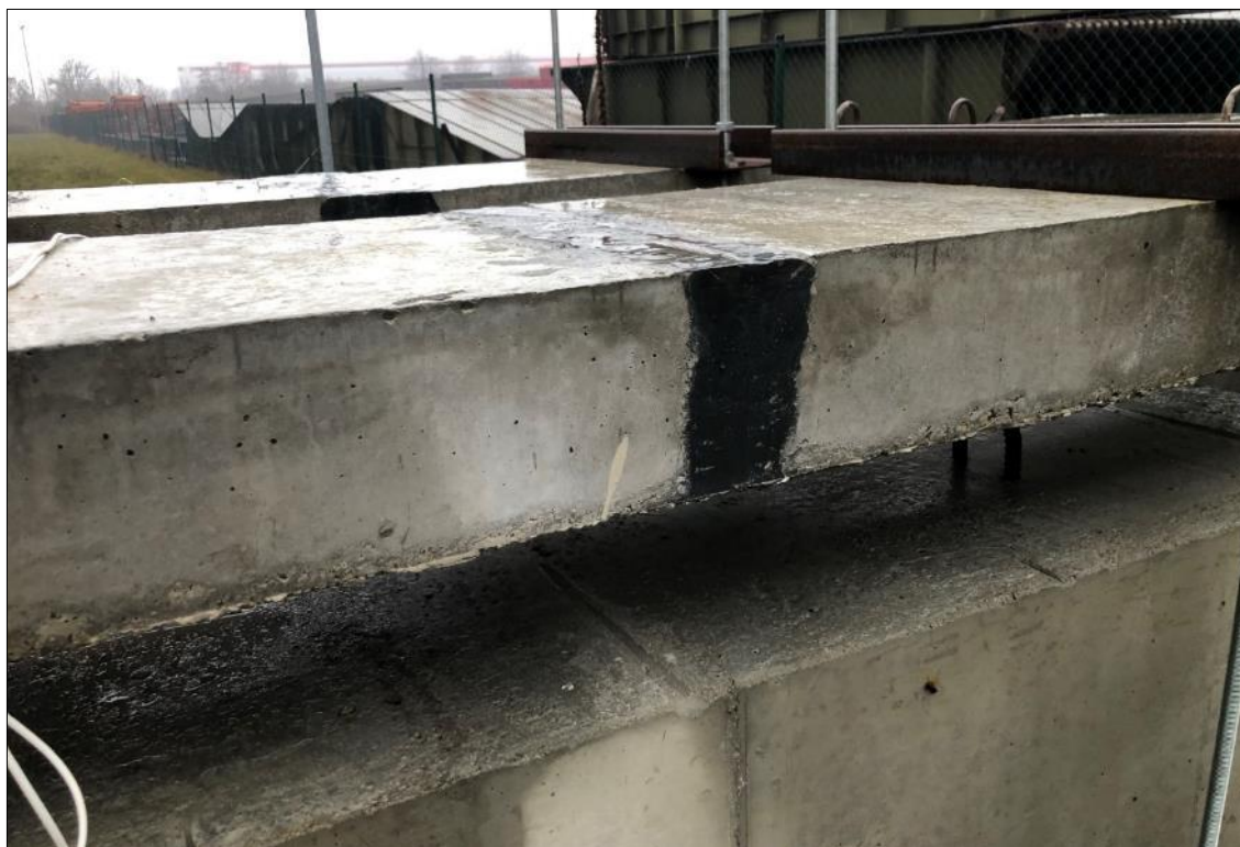
Obr. 117 Pohled na zatěžované desky – vzorek se spojem o šířce 80 mm
