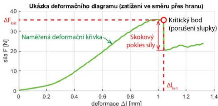
Obr. 3: Ukázka naměřeného deformačního diagramu vzorku 28C s vyznačeným bodem porušení slupky
