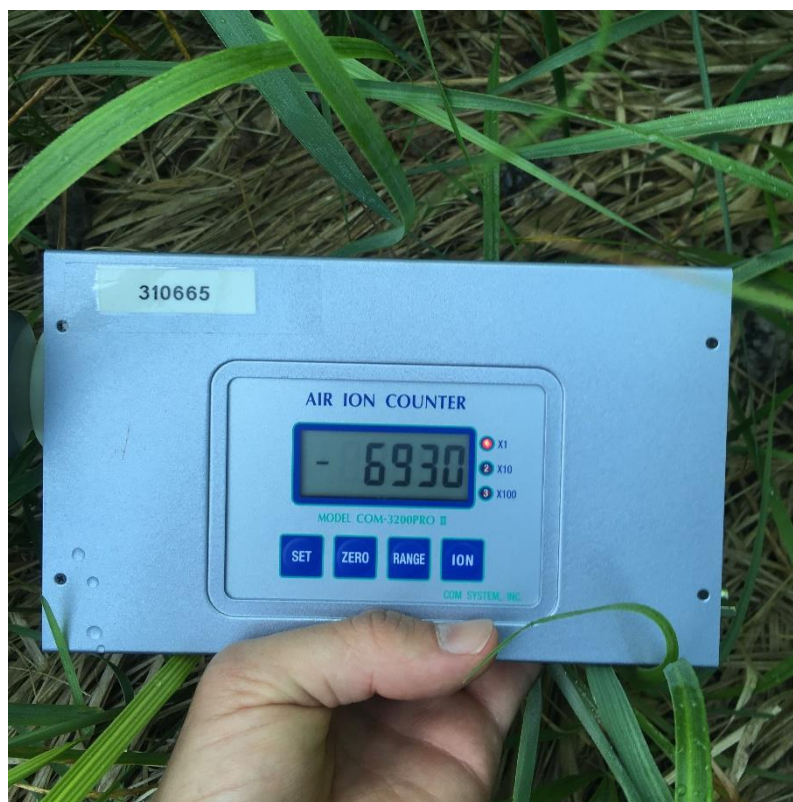
Obrázek 28: Údaj z iontometru naměřený v bodu 11 u paty odvalu (základní rozsah)
