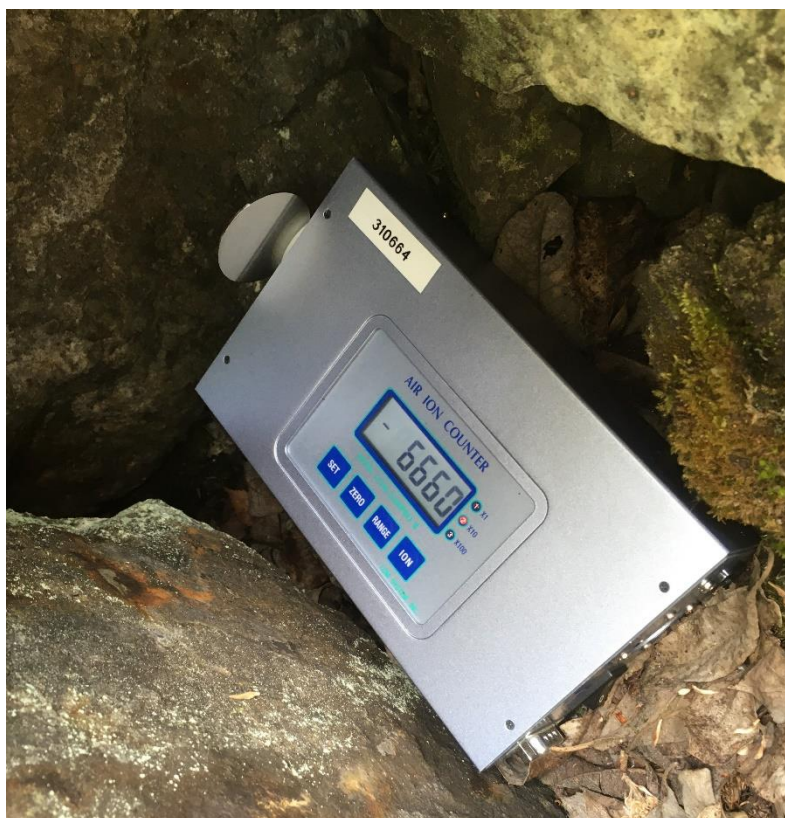
Obrázek 29: Údaj z iontometru naměřený v bodu 7 mezi balvany u paty odvalu (na iontometru je nastaven rozsah X10)
