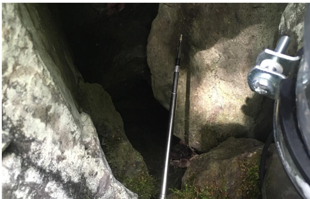
Obrázek 33: Detail měřícího hrotu anemometru umístěného v měřícím bodu 7 u paty odvalu (autor: Václav Štěpán)
