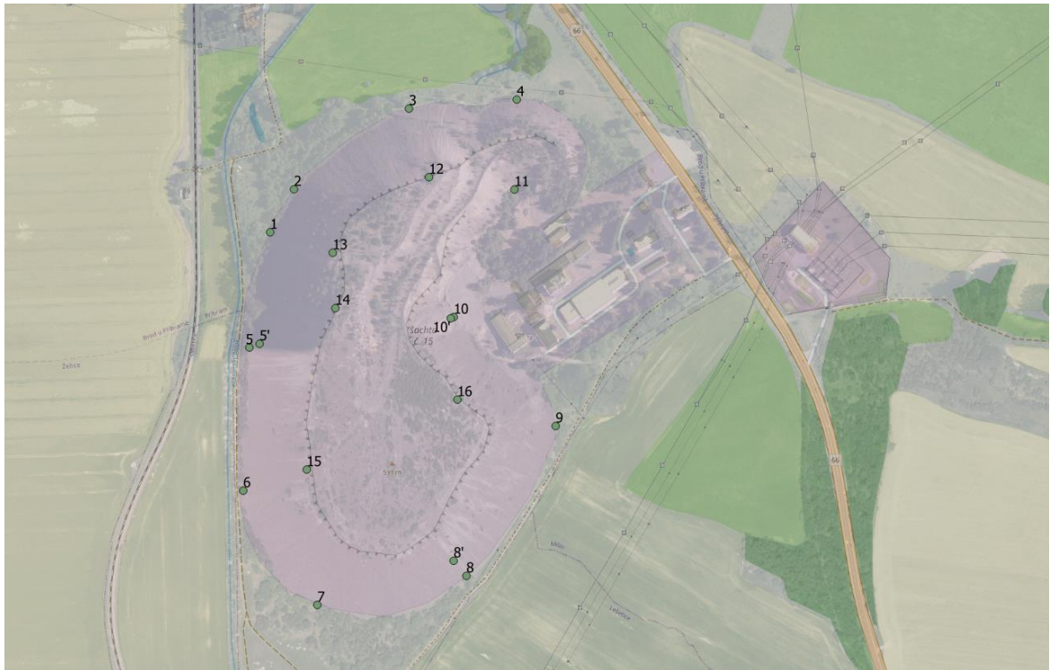
Obrázek 15: Rozmístění sond na odvalu
