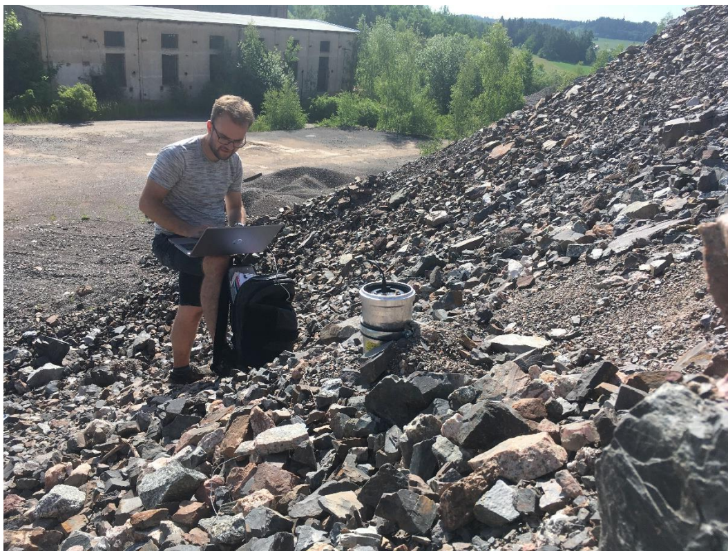
Obrázek 19: Stahování dat ze sondy umístěné na stěně odvalu v bodu 10 přes kabel USB (foto: Václav Štěpán)
