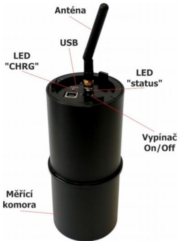
Obrázek 12: Sonda TSR 4 s popisem základních částí [21]
