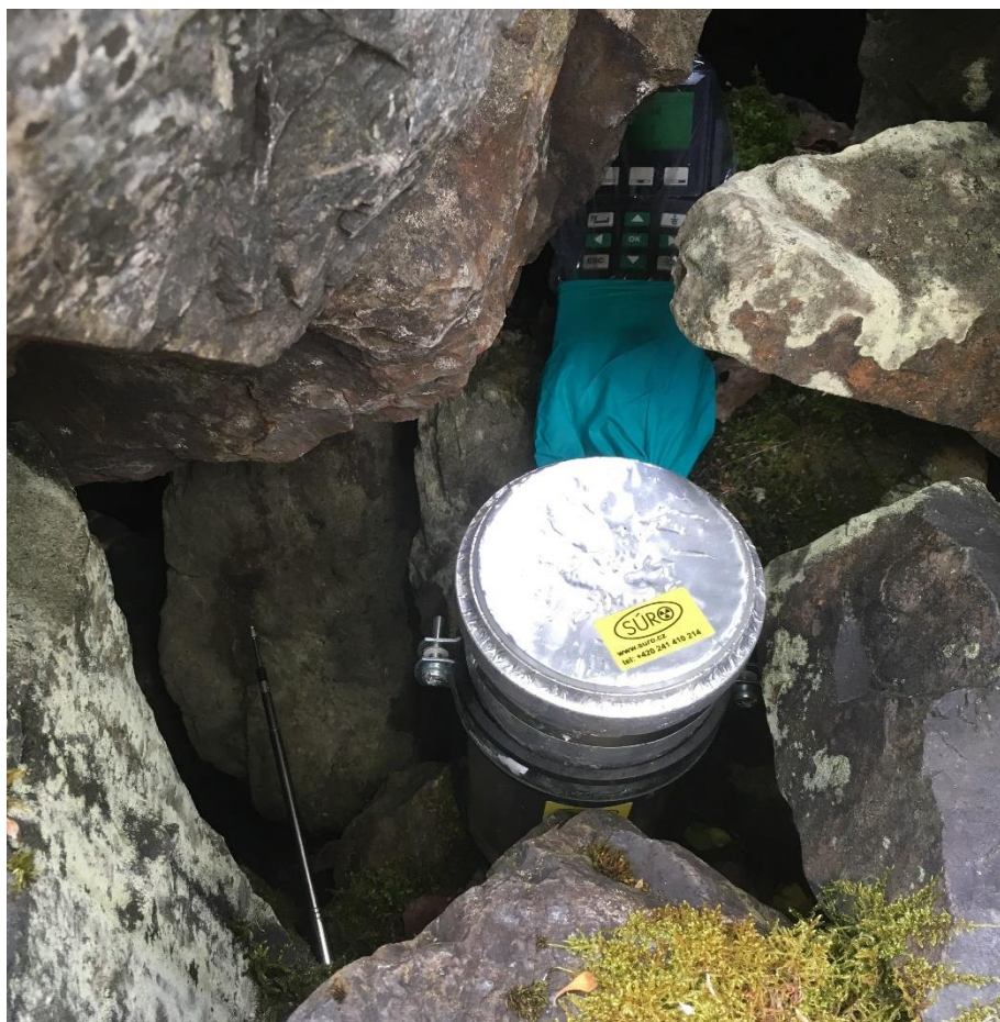
Obrázek 32: Umístění anemometru přímo vedle sondy v měřícím bodu 7 u paty odvalu (autor: Václav Štěpán)
