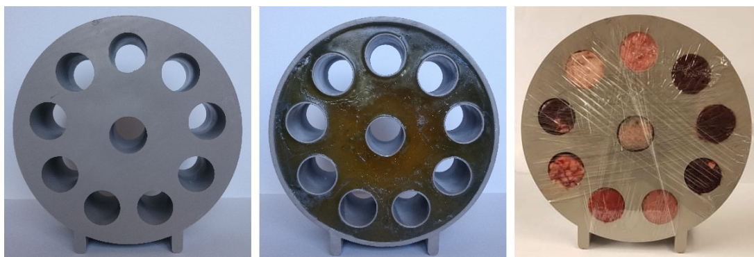
Obrázek 5.8: Fotografie tkáňového fantomu: vlevo nenaplněný fantom z plastové strany, uprostřed nenaplněný fantom z epoxidové strany a vpravo fantom naplněný tkáněmi.
