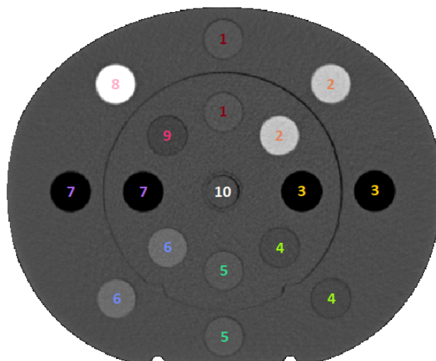
Obrázek 5.1: Rozmístění vložek z tkáňově ekvivalentních materiálů ve fantomu CIRS Electron Density Phantom 062M: 1 = svaly, 2 = kost (s 800 \text{ mg/cm}^3 hydroxyapatitu vápenatého (HA)), 3 = plíce při nádechu, 4 = prsní tkáň, 5 = játra, 6 = kost ( 200 \text{ mg/cm}^3 HA), 7 = plíce při výdechu, 8 = kost ( 1250 \text{ mg/cm}^3 HA), 9 = tuková tkáň, 10 = voda.
