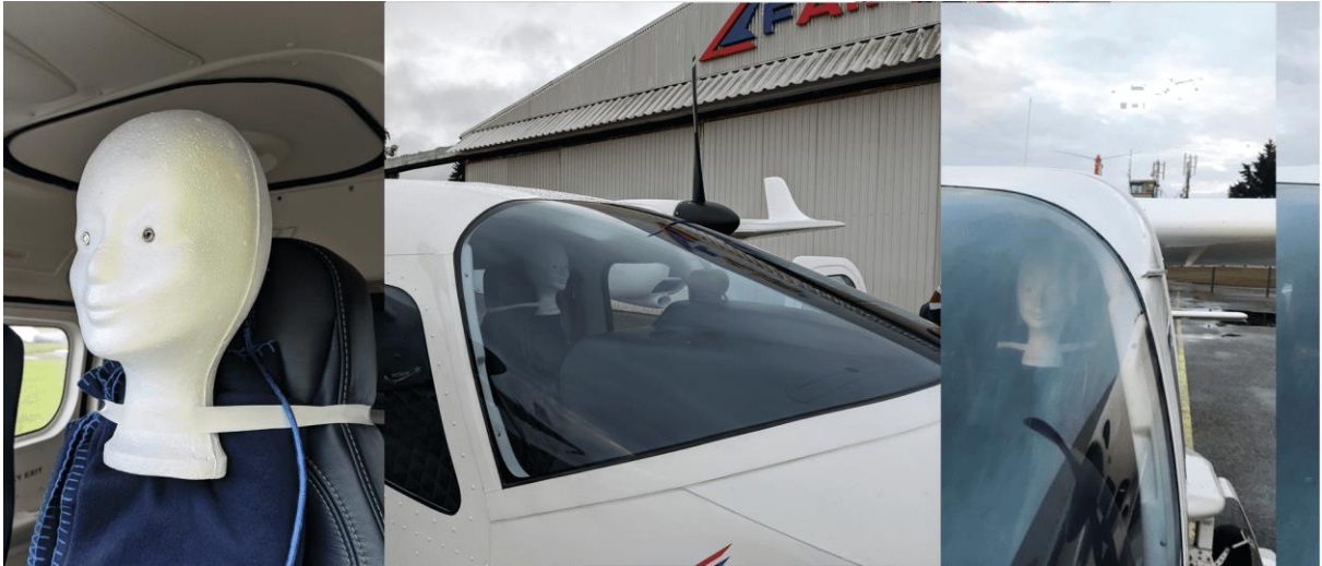
Obrázok 19 Umiestnenie senzoru v lietadle Tecnam P2006T (Autor)
